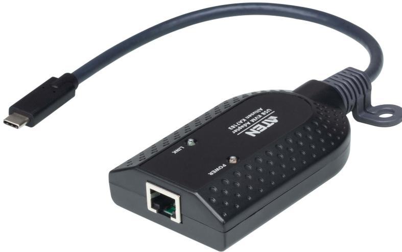
El adaptador KVM KA7183 permite a cualquier conmutador KVM de categoría 5\* conectarse y gestionar un ordenador de destino compatible con USB-C. A través de un solo USB-C puede conectar un ordenador de destino mientras cumple con las funciones de teclado, vídeo, ratón y Virtual Media o lector de tarjetas inteligentes/CAC.
