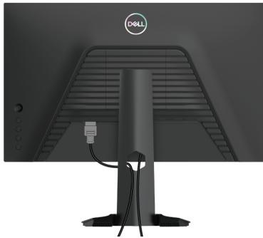
Cuando conecte los cables necesarios (consulte [Conexión de su monitor](#) para obtener más información), pase los cables a través de la ranura de almacenamiento de cable.
