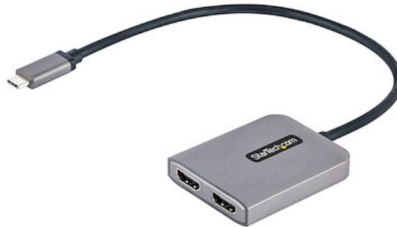
Este Hub MST de USB-C a HDMI le permite conectar dos monitores HDMI, utilizando un dispositivo anfitrión habilitado para USB-C.
