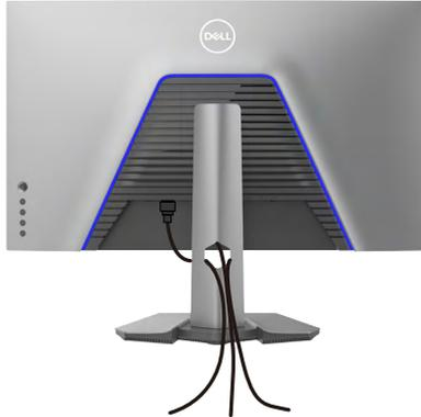
Nach Anschluss aller erforderlichen Kabel an Ihren Monitor und Computer (siehe Ihren **Monitor anschließen** zum Kabelanschluss), organisieren Sie alle Kabel wie oben dargestellt.
