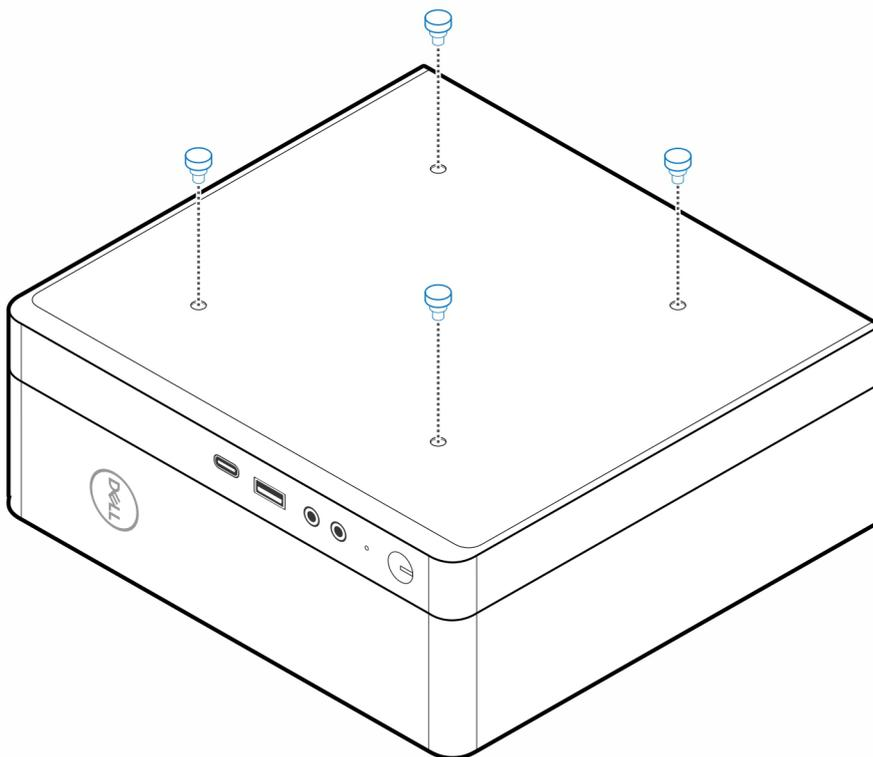
5. Alinee los tornillos pasantes (M4x4) con las muescas del montaje del escritorio y monte la computadora en dicho montaje.
