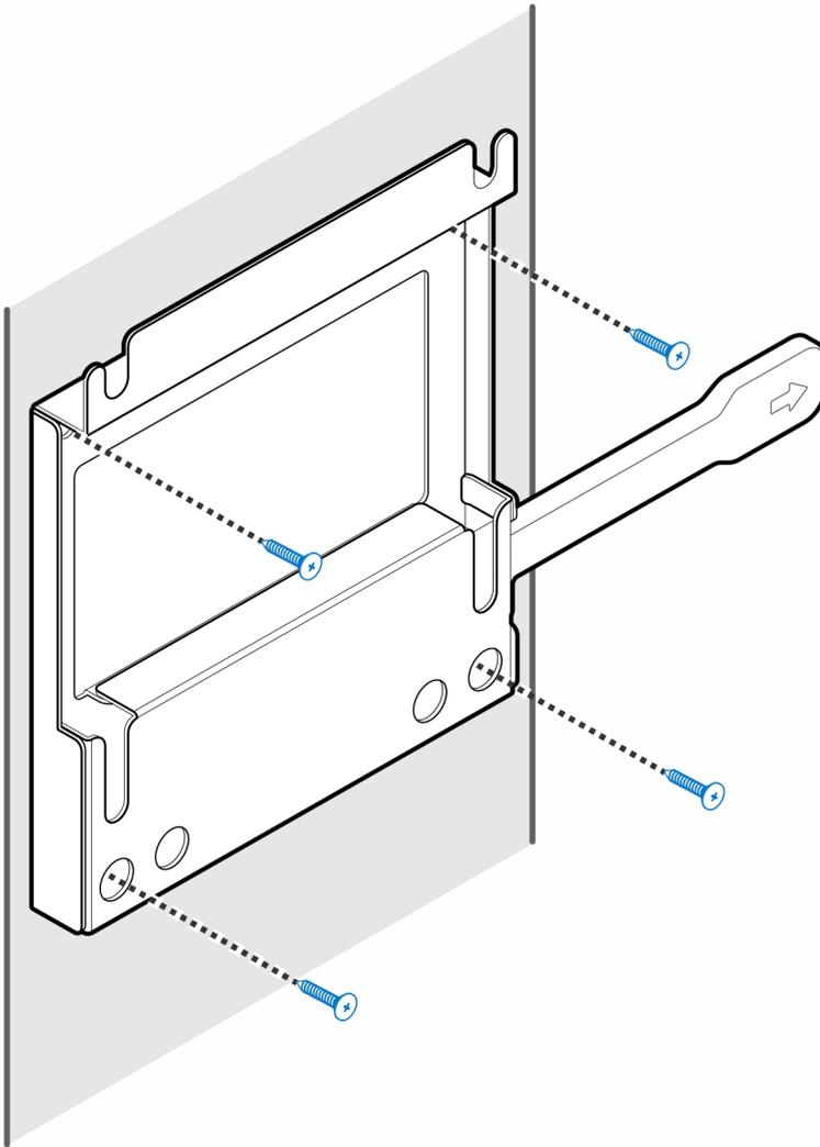
4. Instale los dos tornillos (M3x6) para asegurar la funda del adaptador de CA al montaje VESA.
