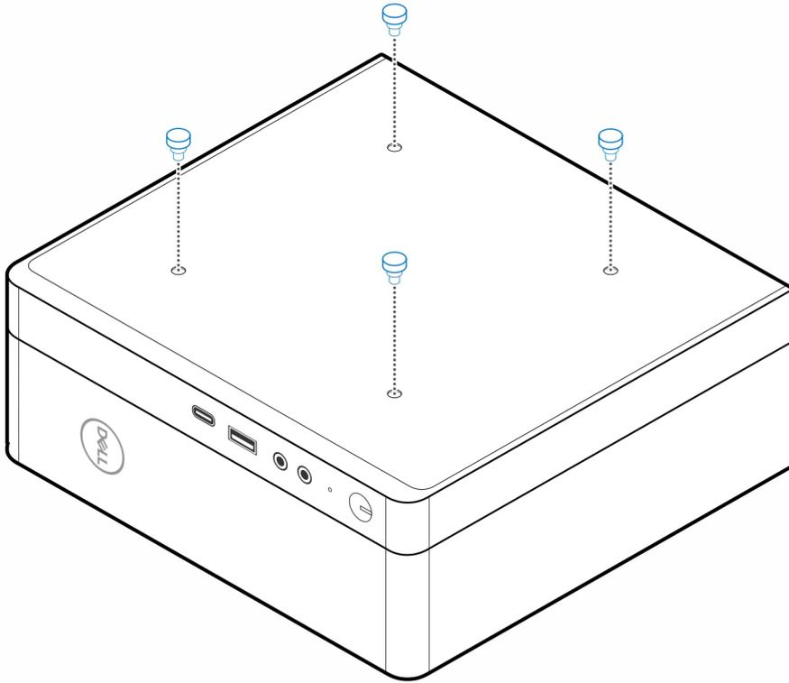
6. Alinee el tornillo pasante (M4x4) con las muescas del montaje de pared y monte la computadora.
