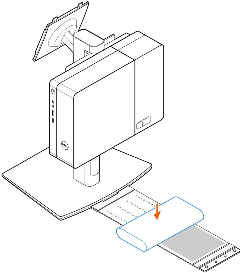
6. Ajuste la funda alrededor del adaptador de CA e inserte las lengüetas de retención en los orificios de dicho adaptador en el nivel apropiado.
