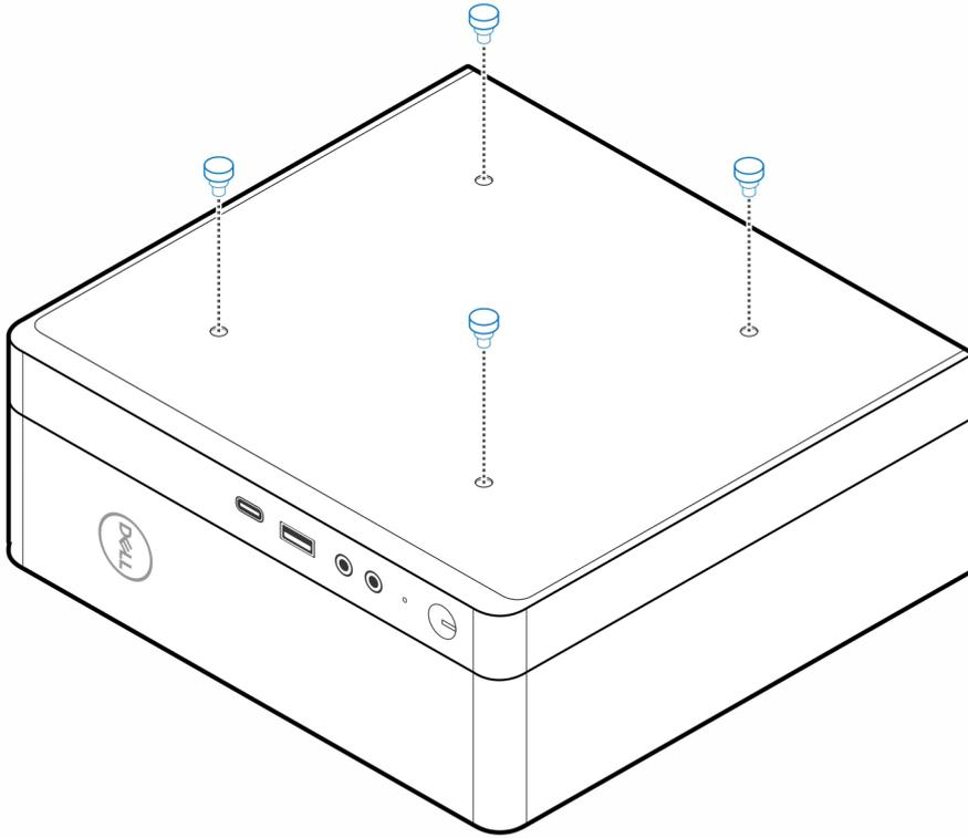
3. Alinee los tornillos pasantes (M4x4) con las muescas de la base todo en uno y monte la computadora en dicho dispositivo.
