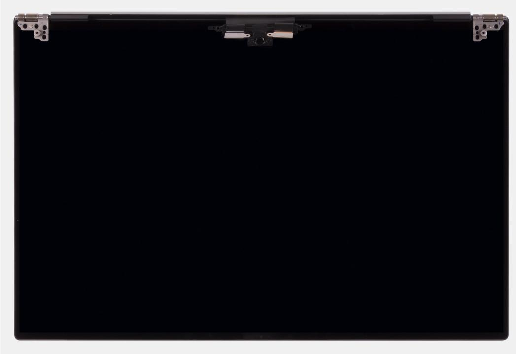
**i** **N.B.:** Il gruppo del display è di tipo Hinge-Up Design (HUD) e non può essere ulteriormente smontato una volta rimosso dalla parte inferiore dello chassis. Se uno dei componenti nel gruppo del display è guasto e deve essere sostituito, sostituire l'intero gruppo.
