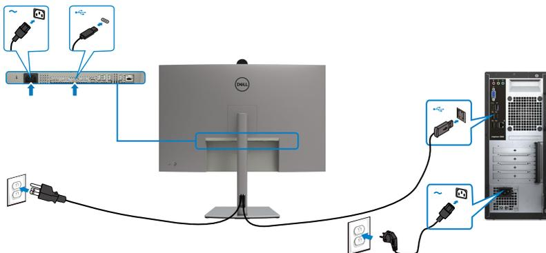
**REMARQUE:** Cette connexion ne contient que des données et aucune vidéo. Il faut une autre connexion vidéo pour l'affichage.
