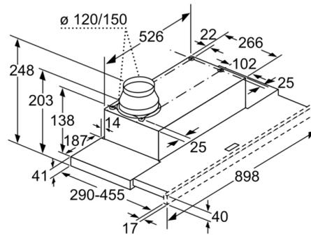
Réglage de la profondeur du tiroir-filtre possible jusqu'à 29 mm
