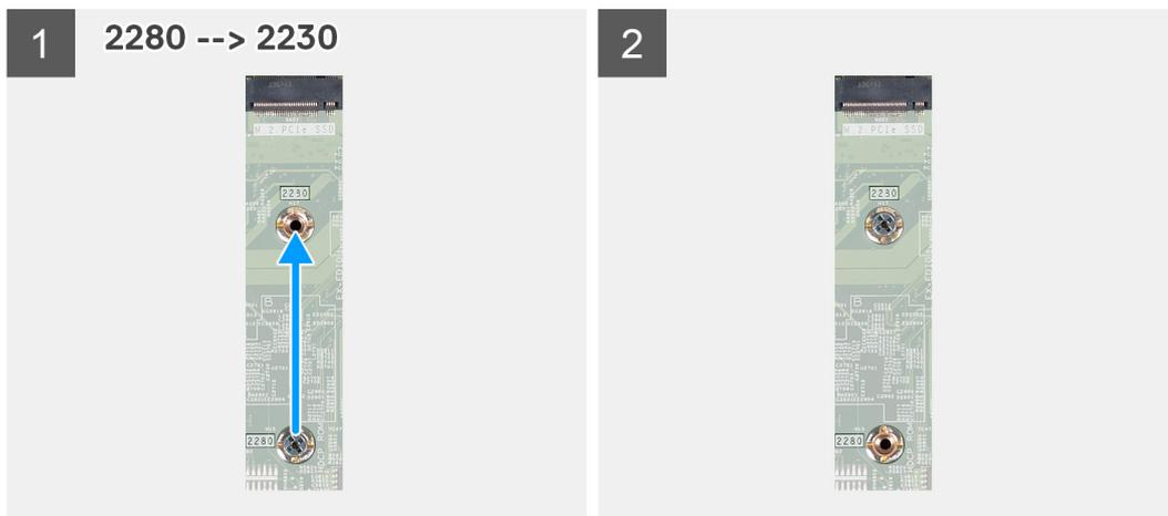
Die folgende Abbildung zeigt die Position des Solid-State-Laufwerks und stellt das Verfahren zum Einbauen bildlich dar.
