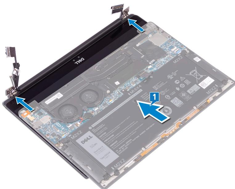
2. Drücken Sie unter Verwendung der Führungstifte die Bildschirmscharniere auf der Handballenstützen-Baugruppe nach unten. Richten Sie dabei die Schraubenbohrungen an den Bildschirmscharnieren an den Schraubenbohrungen der Handballenstützen-Baugruppe aus.
