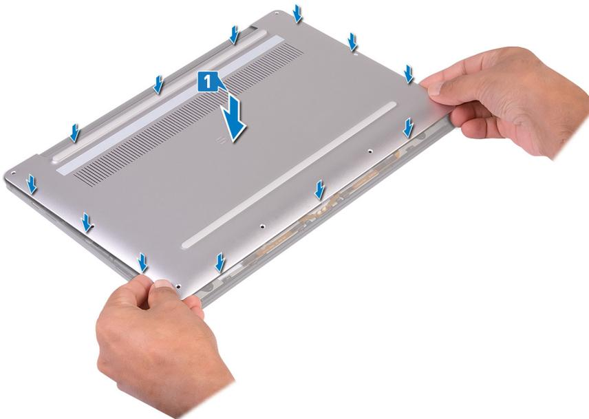
2. Bringen Sie die acht Schrauben (M2x3, Torx) wieder an, mit denen die Bodenabdeckung an der Handballenstützen-Baugruppe befestigt wird.
