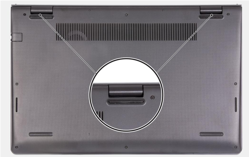
4. Schieben und heben Sie die Bodenabdeckung von der Handballenstützen- und Tastaturbaugruppe ab.
