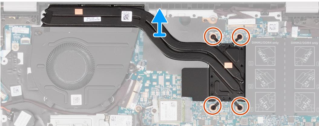
**ANMERKUNG:** Dies ist der Kühlkörper für Ihren Computer, der die **integrierte** GPU (Grafikkarte) unterstützt.
