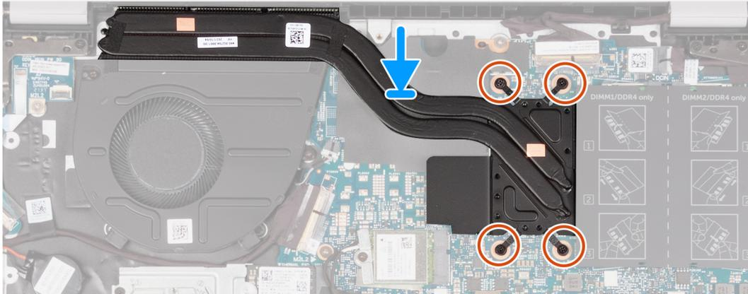
**ANMERKUNG:** Dies ist der Kühlkörper für Ihren Computer, der die **integrierte GPU** (Grafikkarte) unterstützt.
