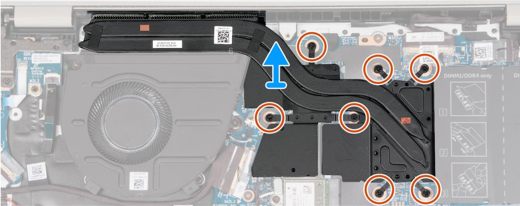
**ANMERKUNG:** Dies ist der Kühlkörper für Ihren Computer, der die **separate** GPU (Grafikkarte) unterstützt.
