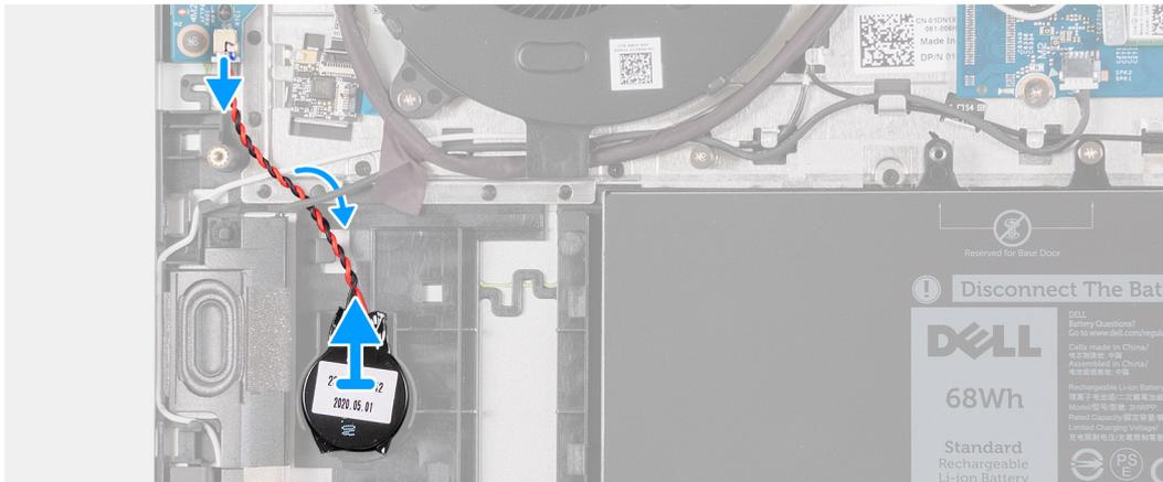
1. Trennen Sie das Kabel der Knopfzellenbatterie von der I/O-Platine.
