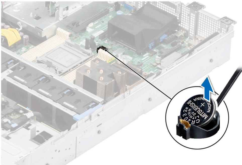
Figure 90. Retrait de la pile du système
