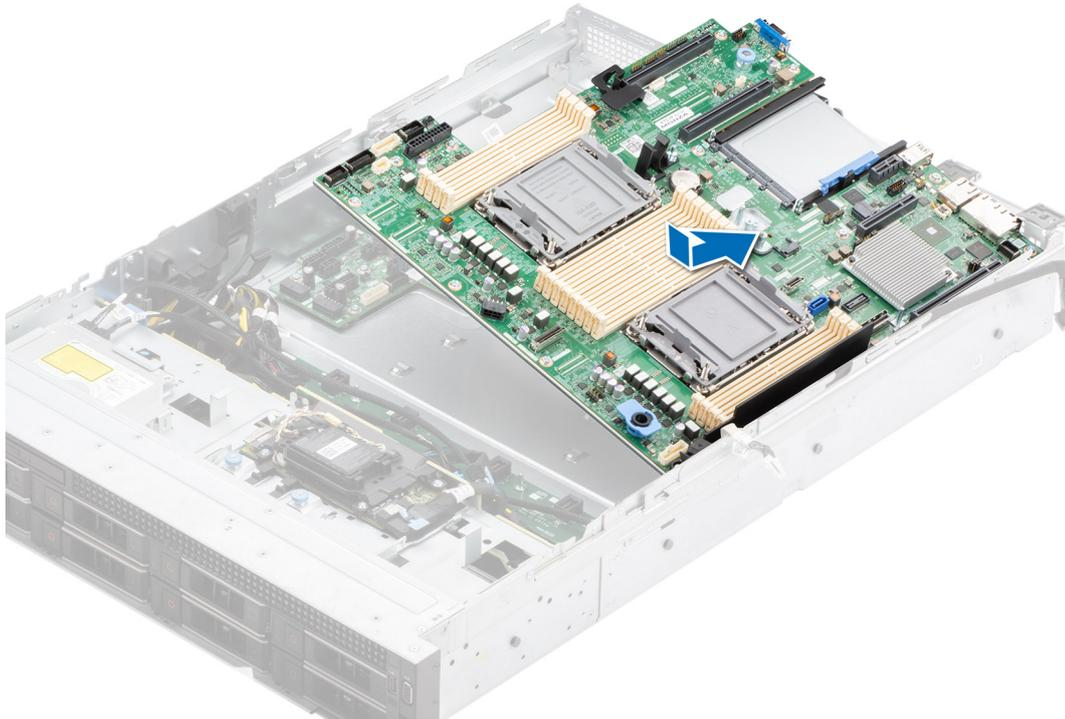
**Figure 105. Installation de la carte système**
