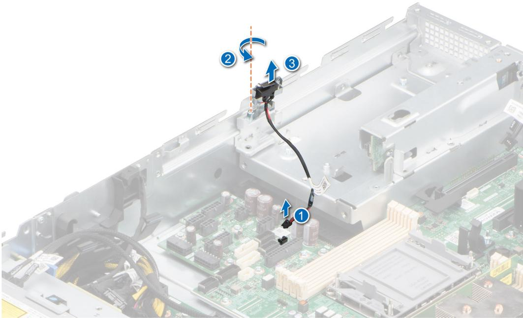
Figure 32. Retrait du module du commutateur d'intrusion
