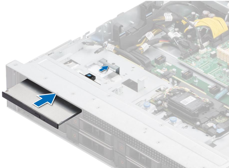
**Figure 112. Installation du lecteur de disque optique**
