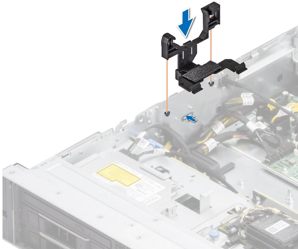
Figure 31. Installation du support de paroi latérale
