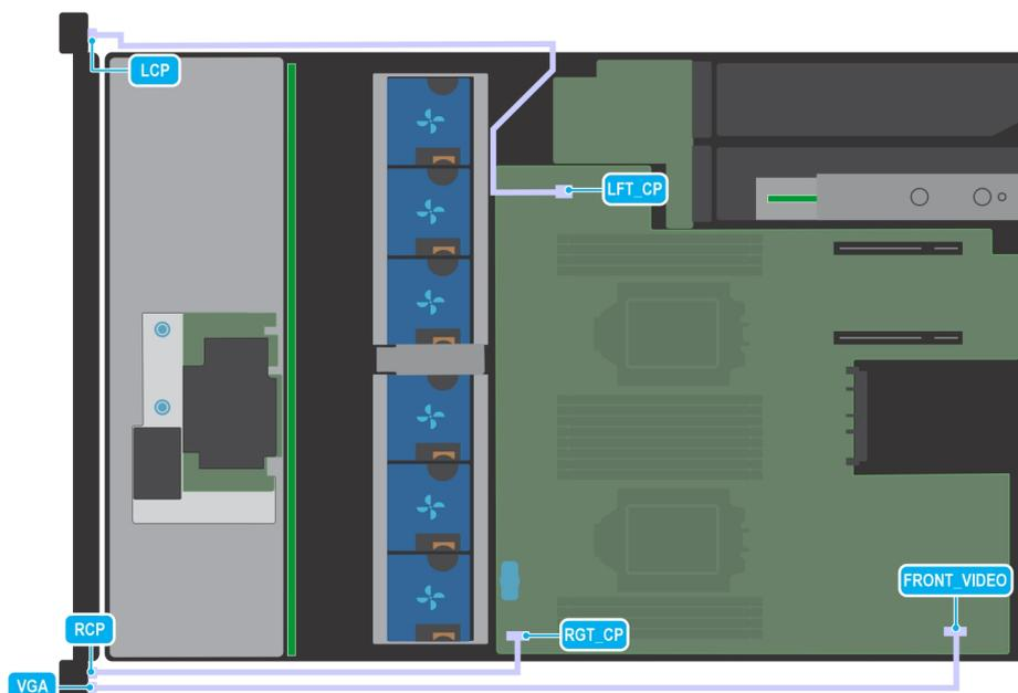
Figure 51. VGA et panneau de configuration
