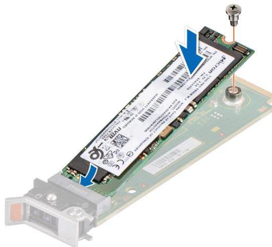
**Figure 82. Installation du disque SSD M.2**
