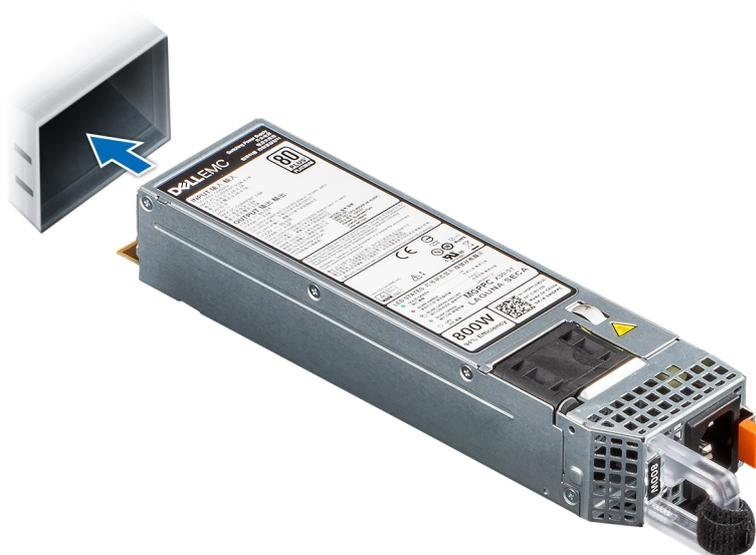
Figure 99. Installation d'un bloc d'alimentation
