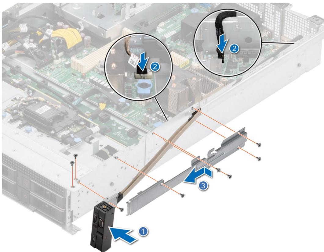
**Figure 110. Installation du panneau de configuration droit**
