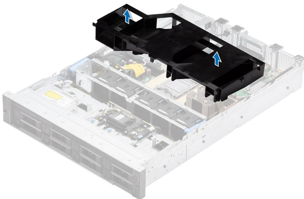
Figure 24. Retrait du carénage d'aération
