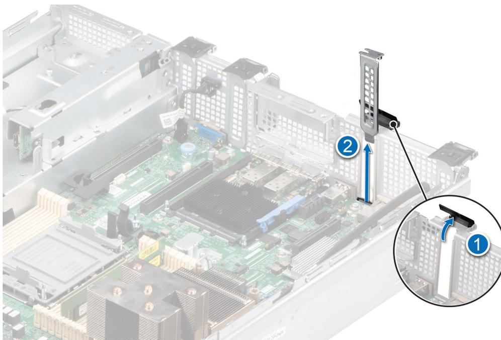
Figure 70. Retrait de la plaque de recouvrement
