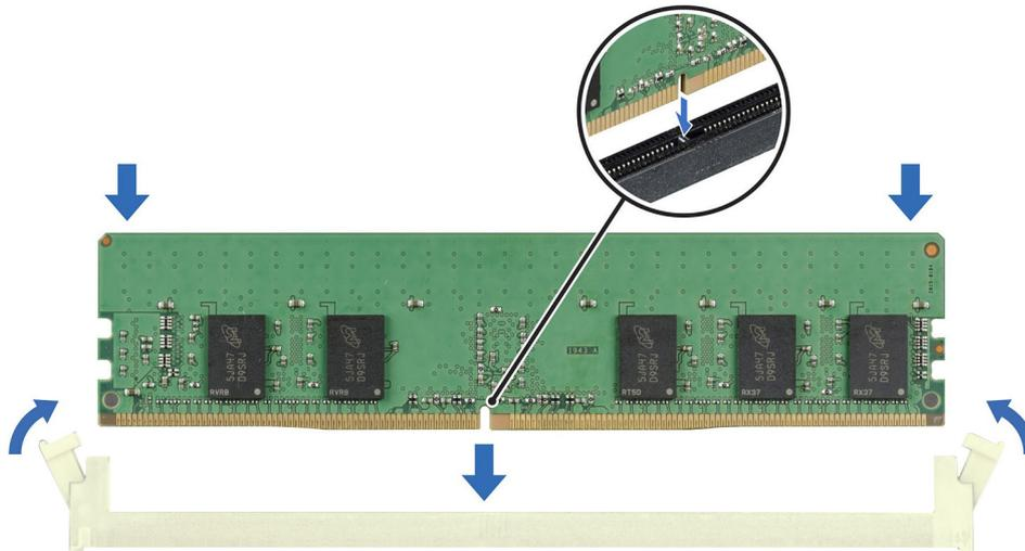
Figure 54. Installation d'un module de mémoire
