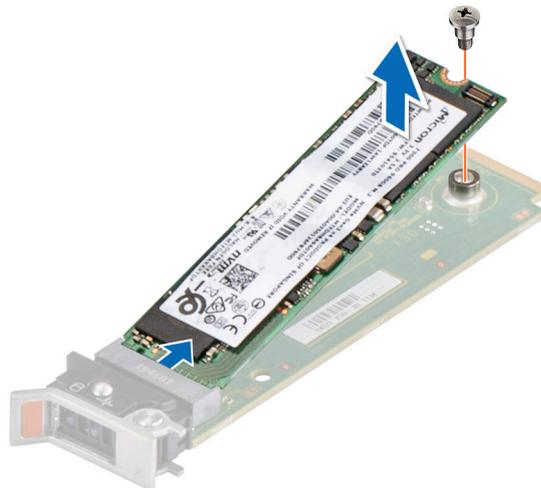
**Figure 75. Retrait du disque SSD M.2**
