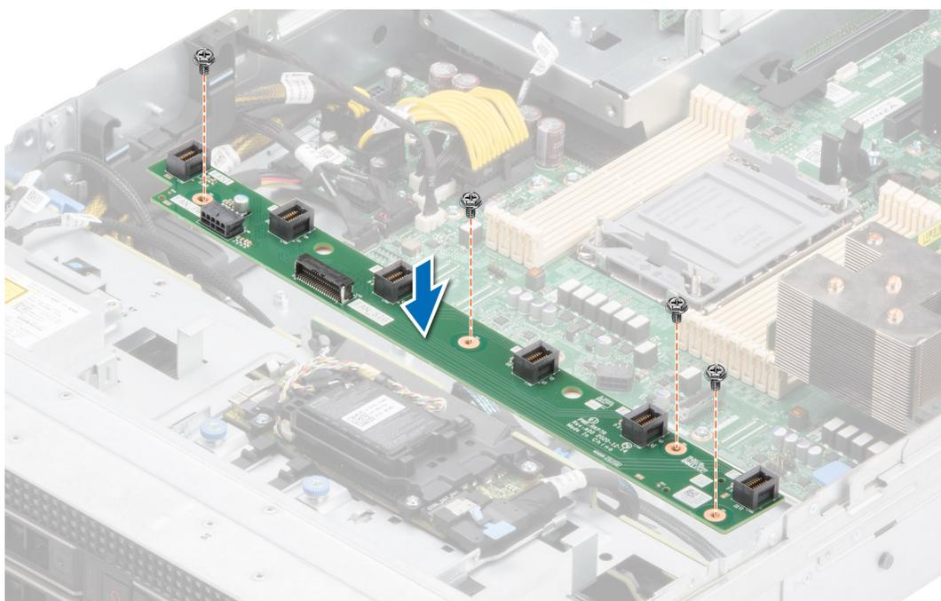
Figure 103. Installation d'une carte de bâti de ventilateur
