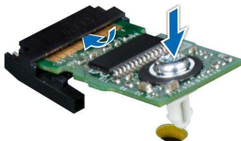
Figure 106. Installation du module TPM
