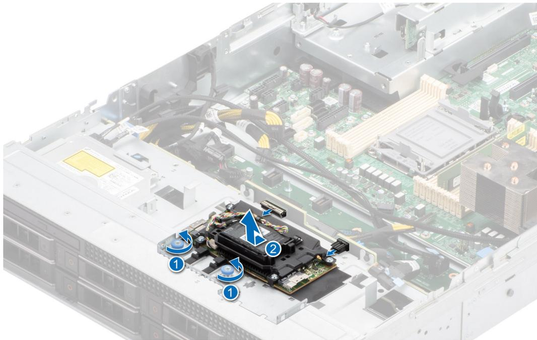
Figure 84. Retrait du module PERC avant à montage avant
