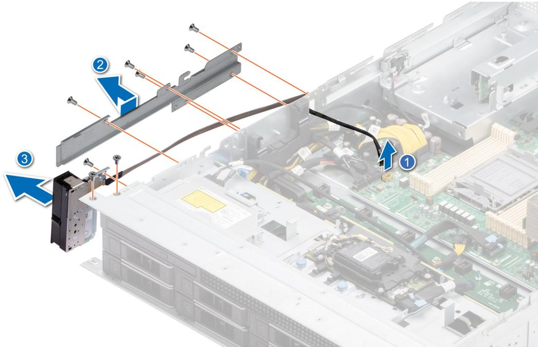
Figure 107. Retrait du panneau de configuration gauche
