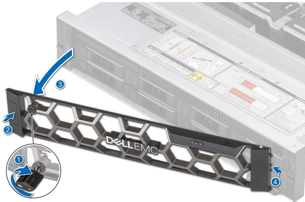
Figure 18. Retrait du panneau avant avec l'écran LCD
