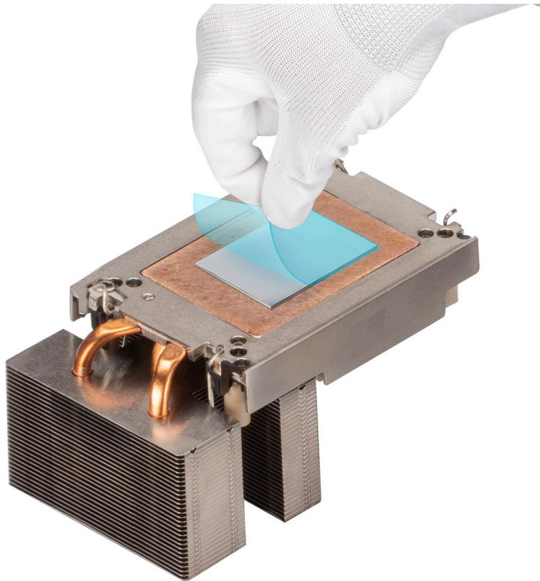
**Figure 63. Retrait du film de protection du matériau d'interface thermique (TIM)**
