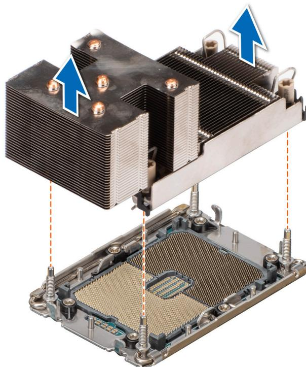
Figure 56. Retrait du dissipateur de chaleur du processeur
