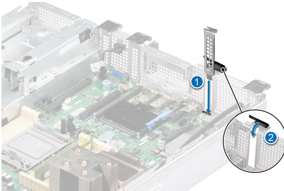
Figure 69. Installation de la plaque de recouvrement
