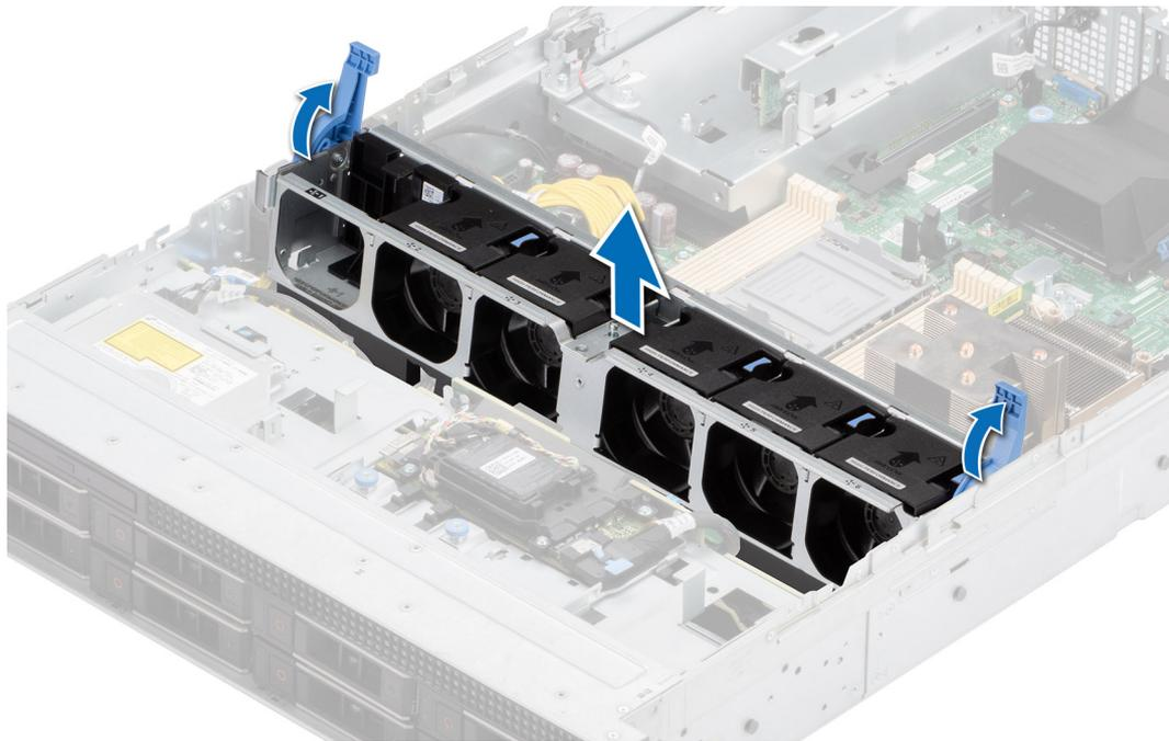
Figure 26. Retrait de l'assemblage du bâti du ventilateur
