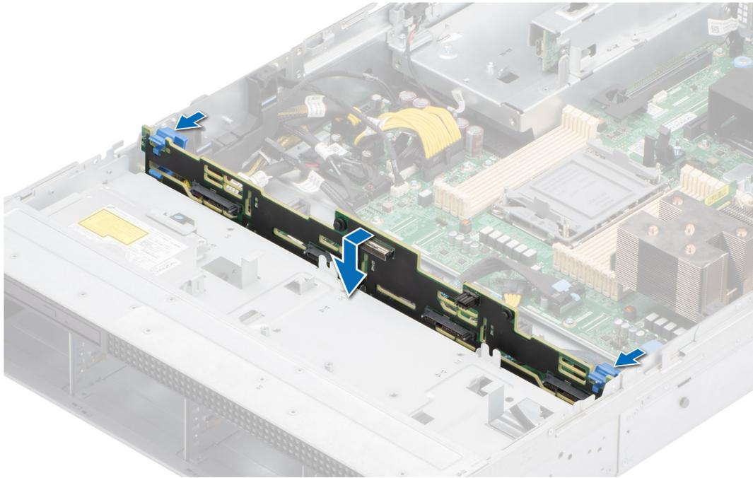
**Figure 46. Installation du fond de panier de disque**
