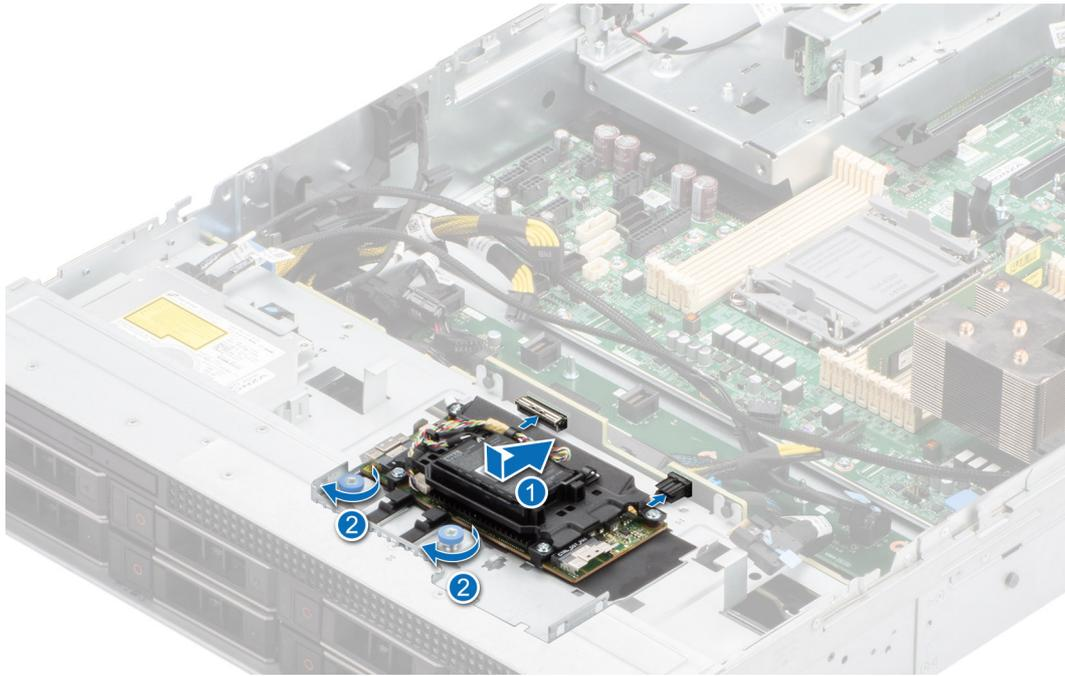
Figure 85. Installation du module PERC avant à montage avant
