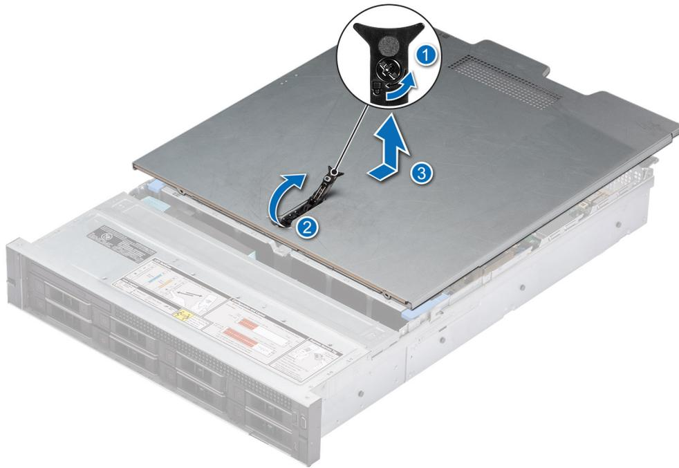
Figure 20. Retrait du capot du système
