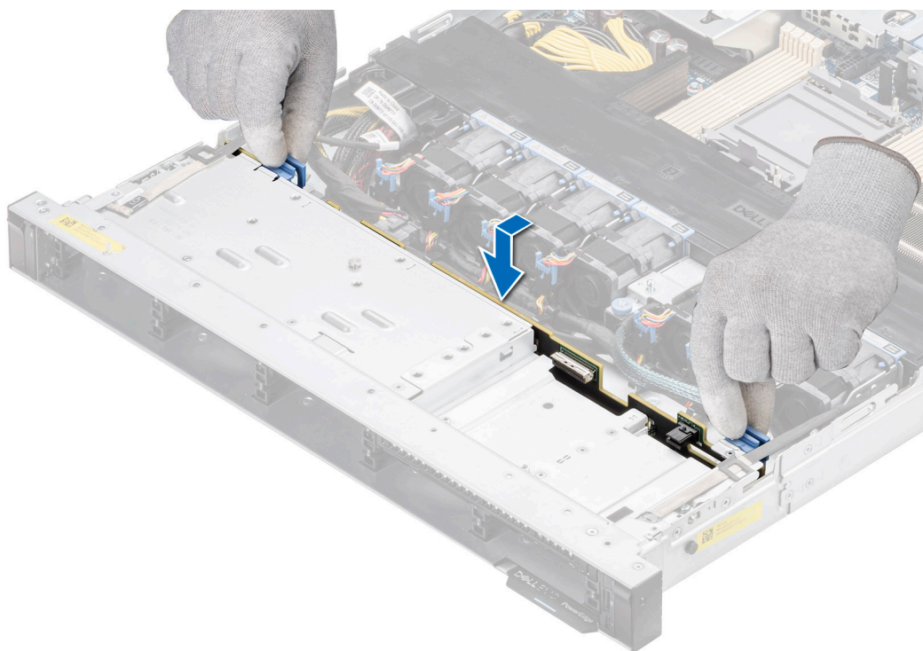
Figure 38. Installation du fond de panier de disque
