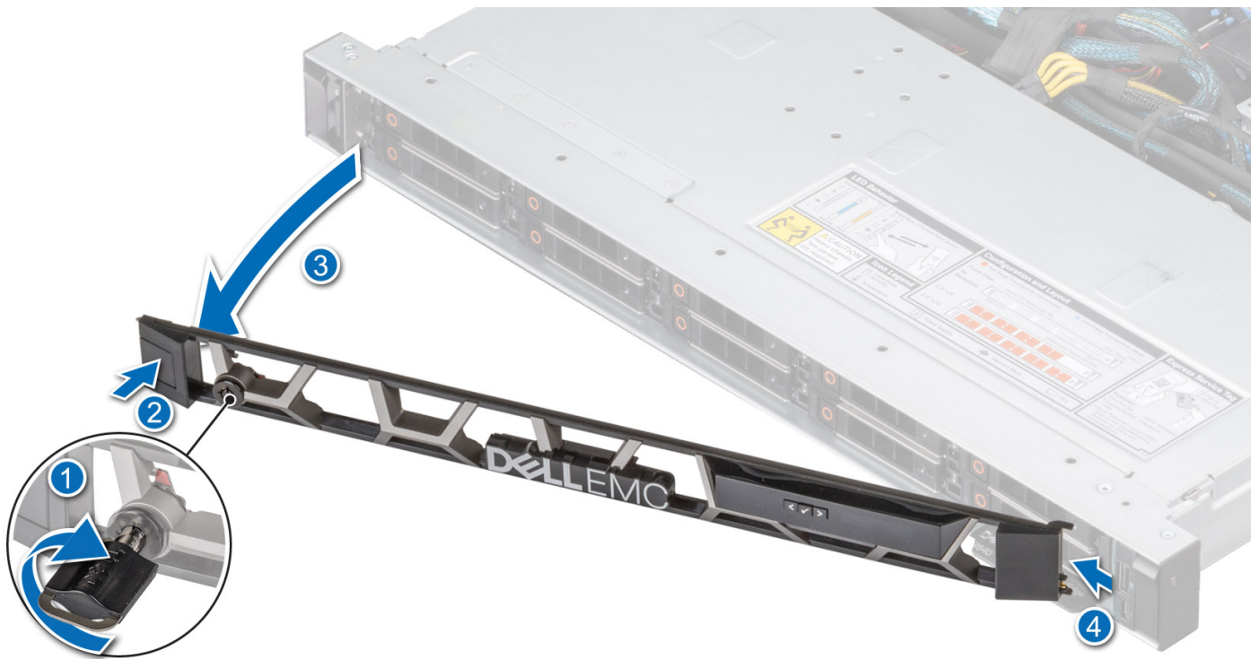
Figure 15. Retrait du panneau avant avec l'écran LCD
