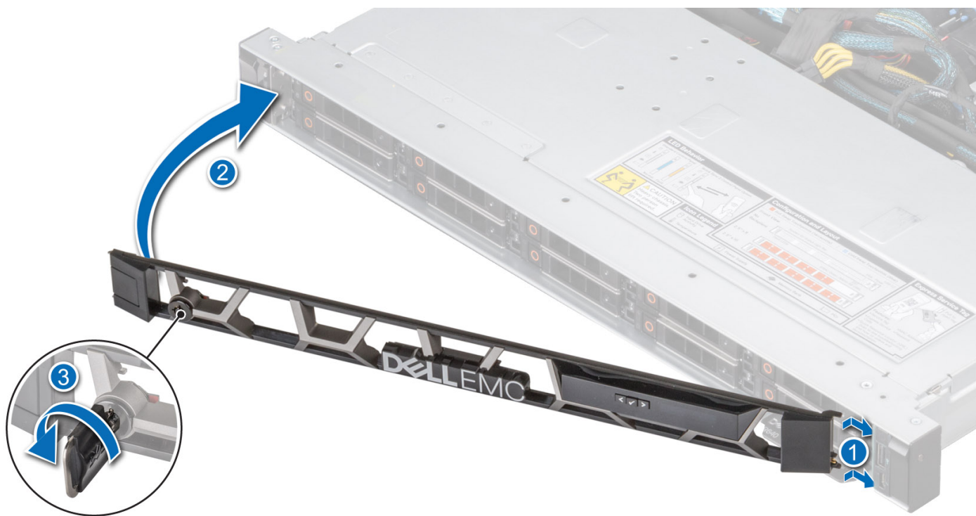
Figure 16. Installation du panneau avant avec l'écran LCD
