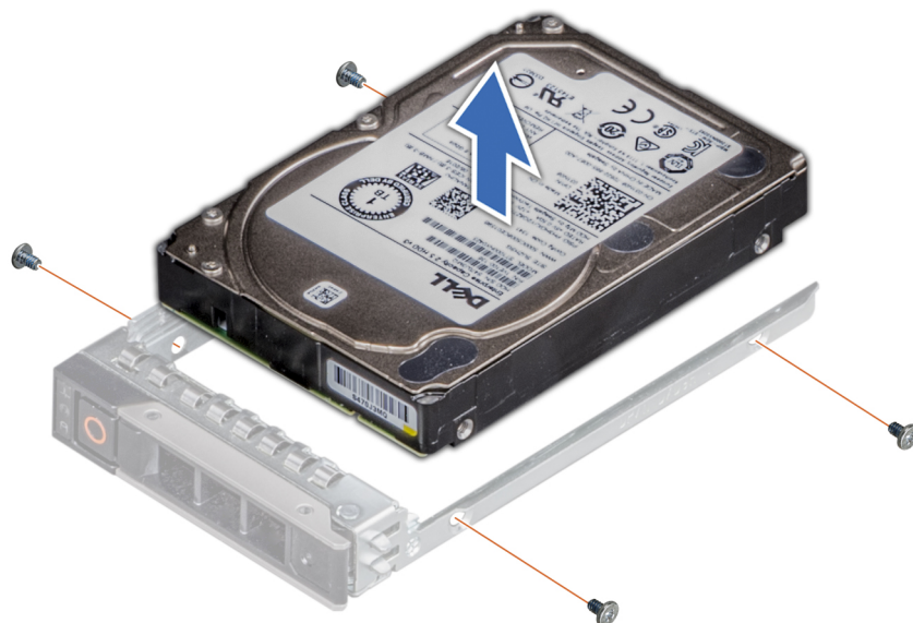
Ilustración 40. Extracción de una unidad del portaunidades
