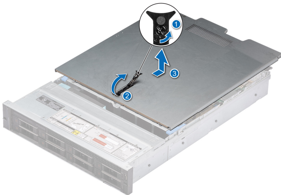
Ilustración 20. Extracción de la cubierta del sistema
