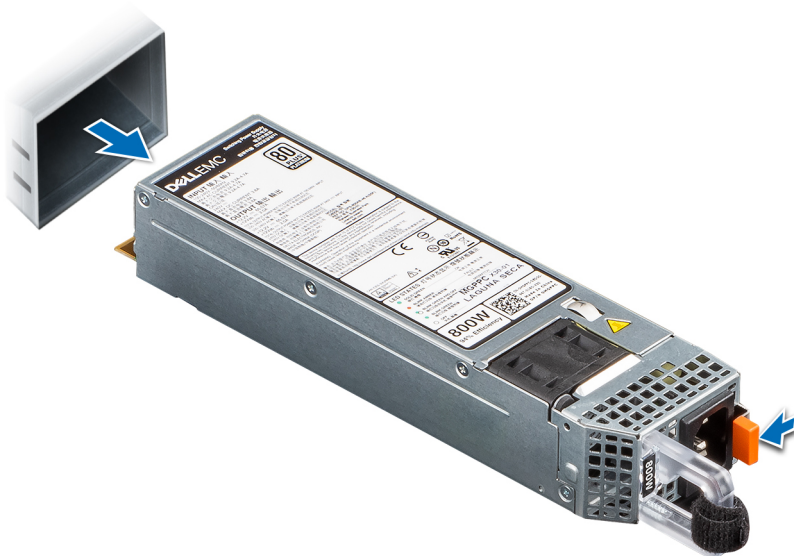
Ilustración 100. Extracción de una unidad de fuente de alimentación
