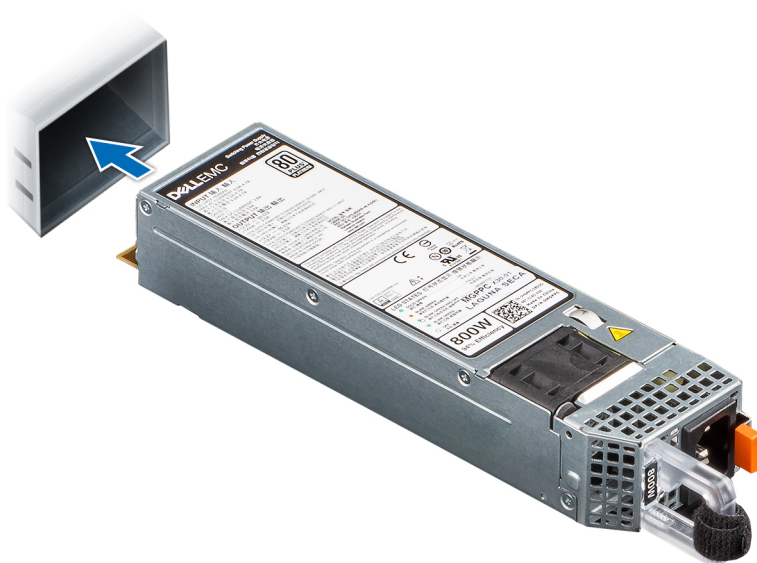
Ilustración 101. Instalación de una fuente de alimentación
