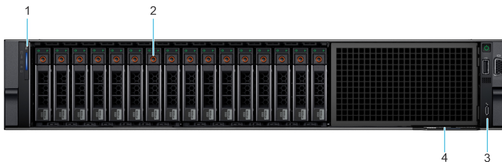
Abbildung 1. Vorderansicht eines Systems mit 16 x 2,5-Zoll-Laufwerken
