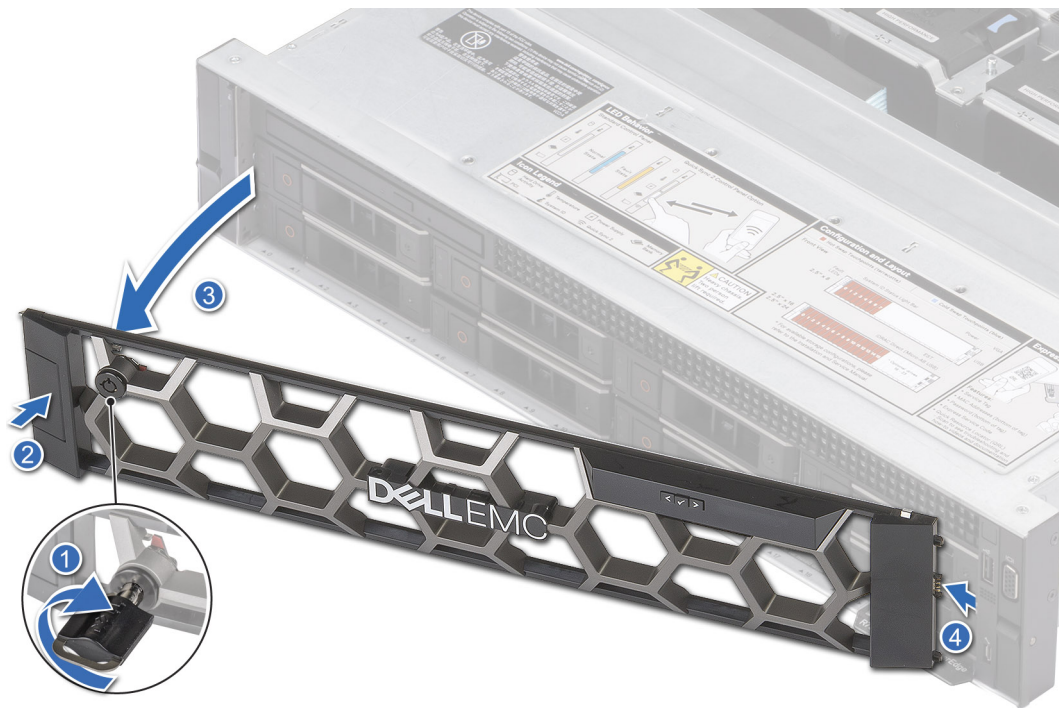
Abbildung 18. Entfernen der Frontblende mit LCD-Display
