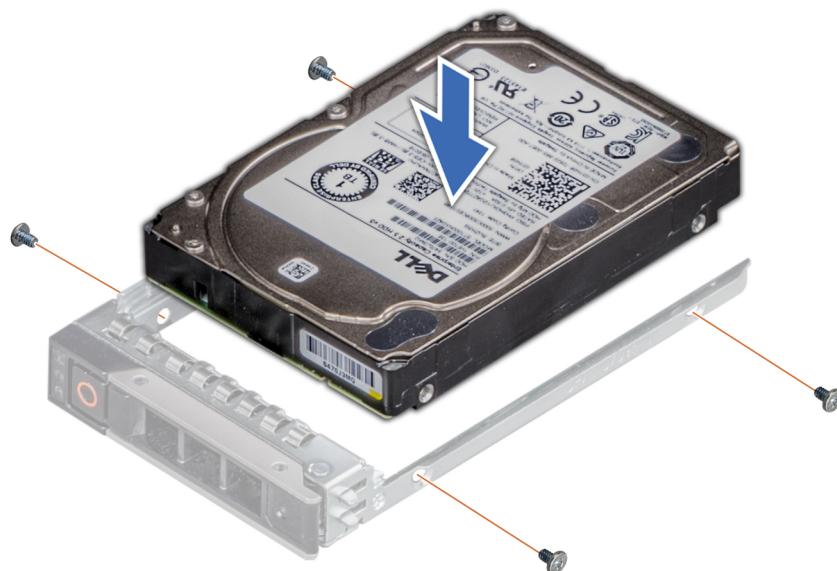
Abbildung 41. Einsetzen eines Laufwerks in den Laufwerkträger
