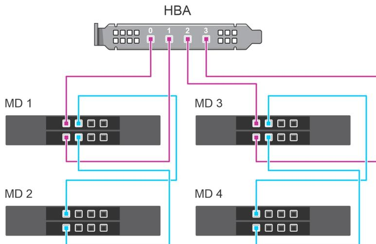
Abbildung 14. Multipath-Konfiguration: Verkabelung des HBA355e-Adapter mit MD1420- und MD1400-Gehäusen
