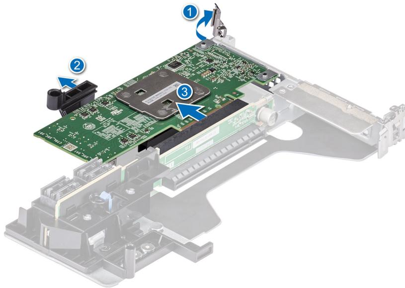
Abbildung 6. Entfernen des Dell HBA355i-Adapter
