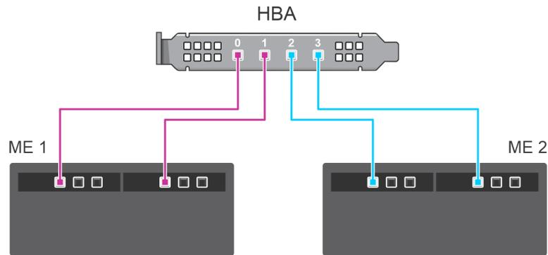
Abbildung 15. Multipath-Konfiguration: Verkabelung des HBA355e-Adapters mit ME484-Gehäusen
