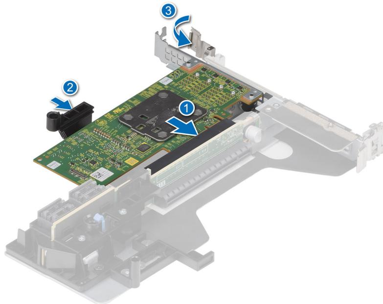
Abbildung 11. Installieren des HBA355e-Adapter
