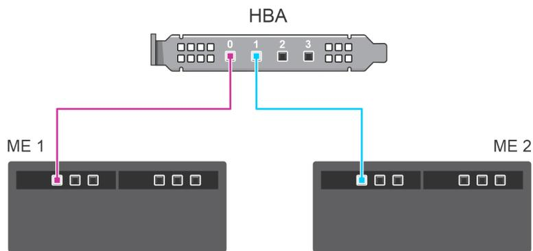
Abbildung 13. Single-Path-Konfiguration: Verkabelung des HBA355e-Adapter mit ME484-Gehäusen
