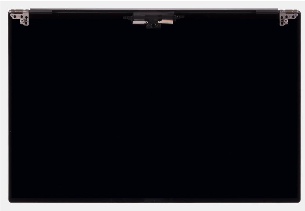
**NOTA:** El ensamblaje de la pantalla tiene un diseño de bisagra hacia arriba (HUD) y no se puede volver a desensamblar una vez quitado del chasis inferior. Si alguno de los componentes del ensamblaje de pantalla no funciona correctamente y se debe reemplazar, reemplace todo el ensamblaje de la pantalla.
