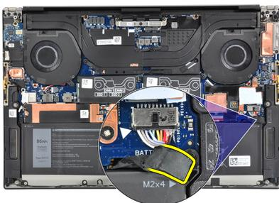
En la imagen a continuación, se indica la ubicación de la batería y se proporciona una representación visual del procedimiento de extracción.
