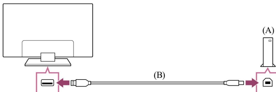
(A) Dispositivo HDD USB
