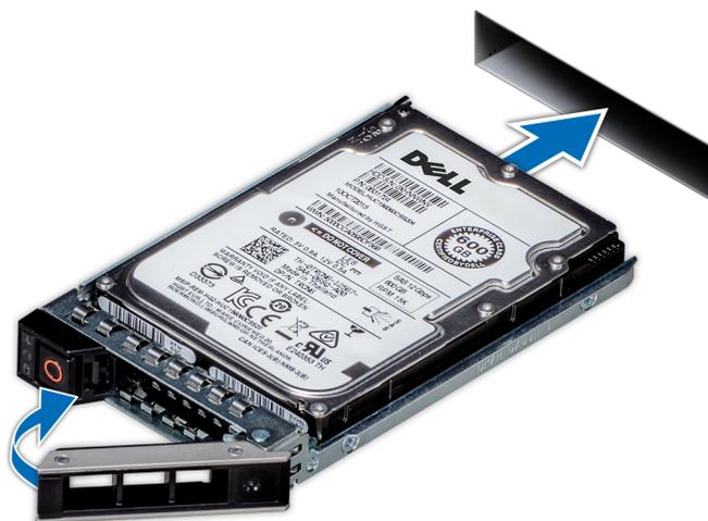
Figure 43. Installation d'un support de disque
