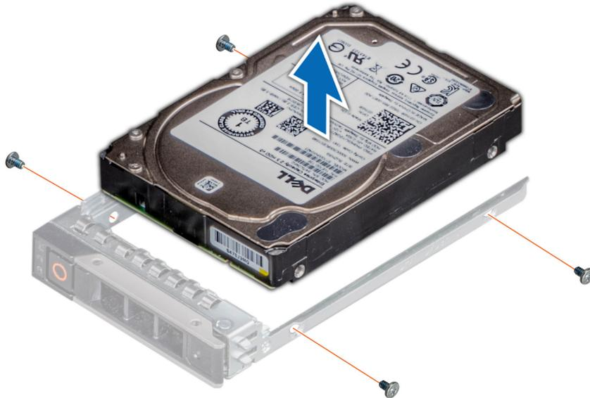
Figure 44. Retrait d'un disque installé dans un support de disque
