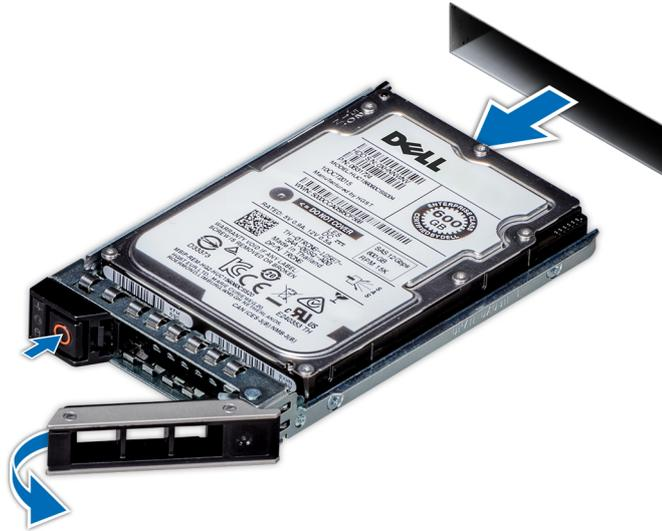
Ilustración 42. Extracción de un portaunidades
