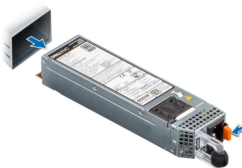
**Ilustración 144. Extracción de una fuente de alimentación**
