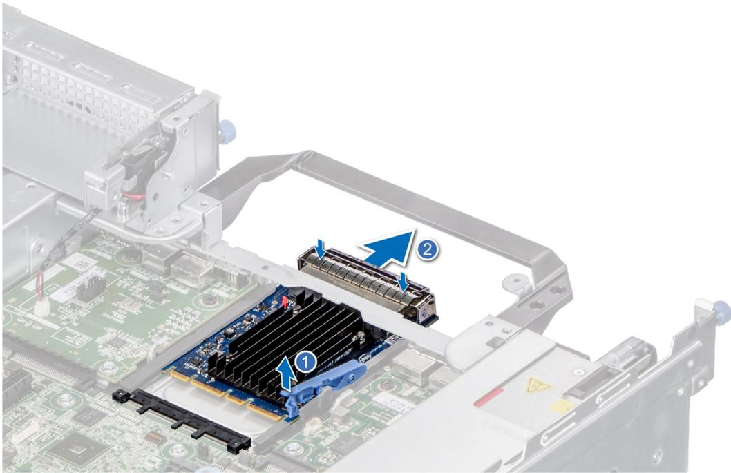
**Ilustración 140. Extracción de la tarjeta OCP**
