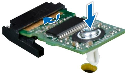
Ilustración 146. Instalación del TPM
