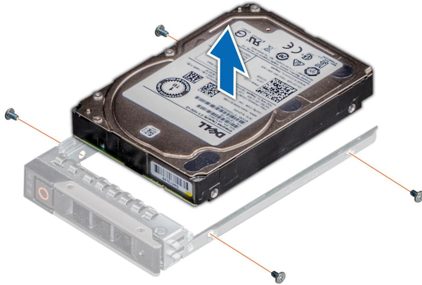
**Ilustración 44. Extracción de una unidad del portaunidades**
