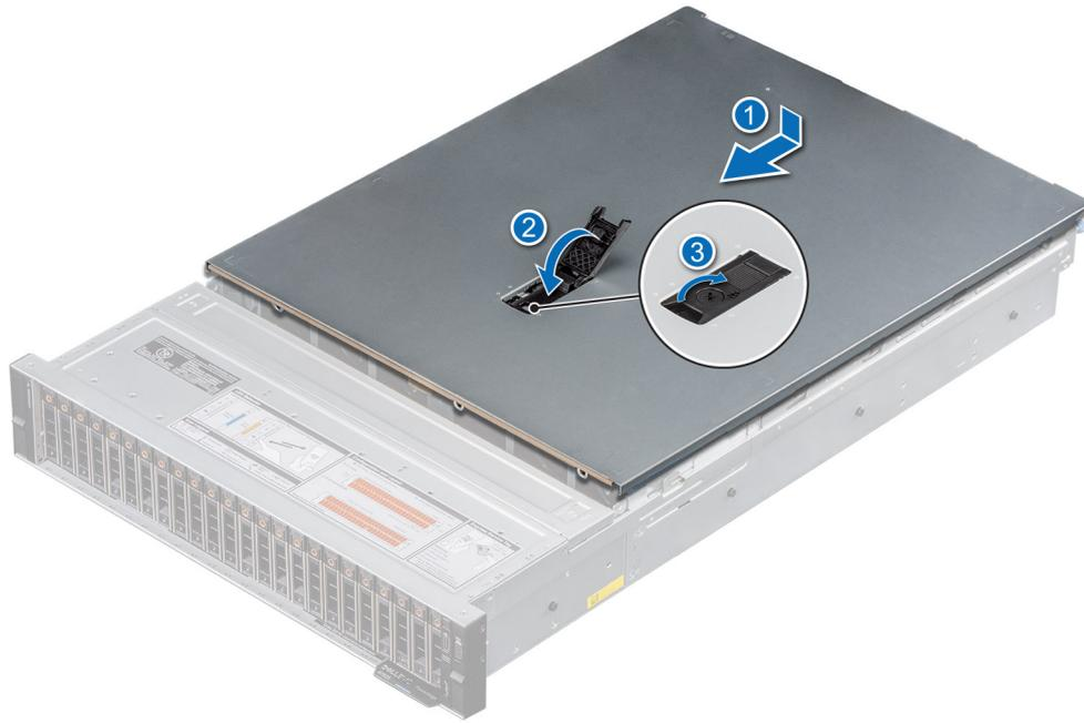
**Ilustración 21. Instalación de la cubierta del sistema**
