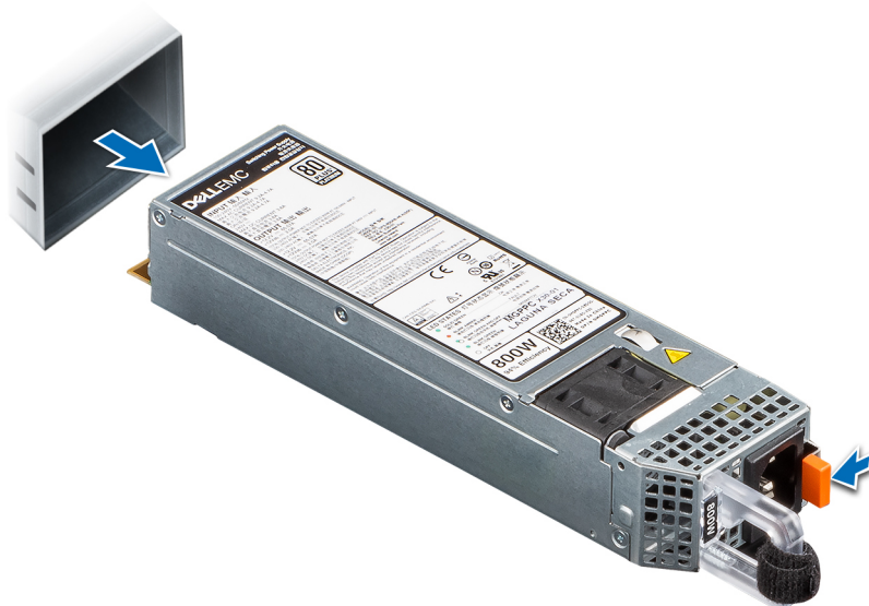
Abbildung 145. Entfernen eines Netzteils
