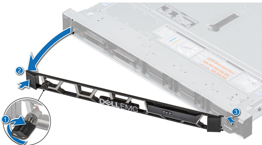
Abbildung 15. Entfernen der Frontblende mit LCD-Display
