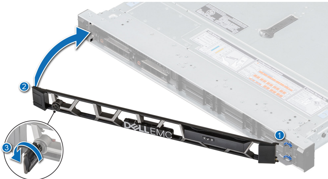
Abbildung 16. Installieren der Frontblende mit LCD-Display
