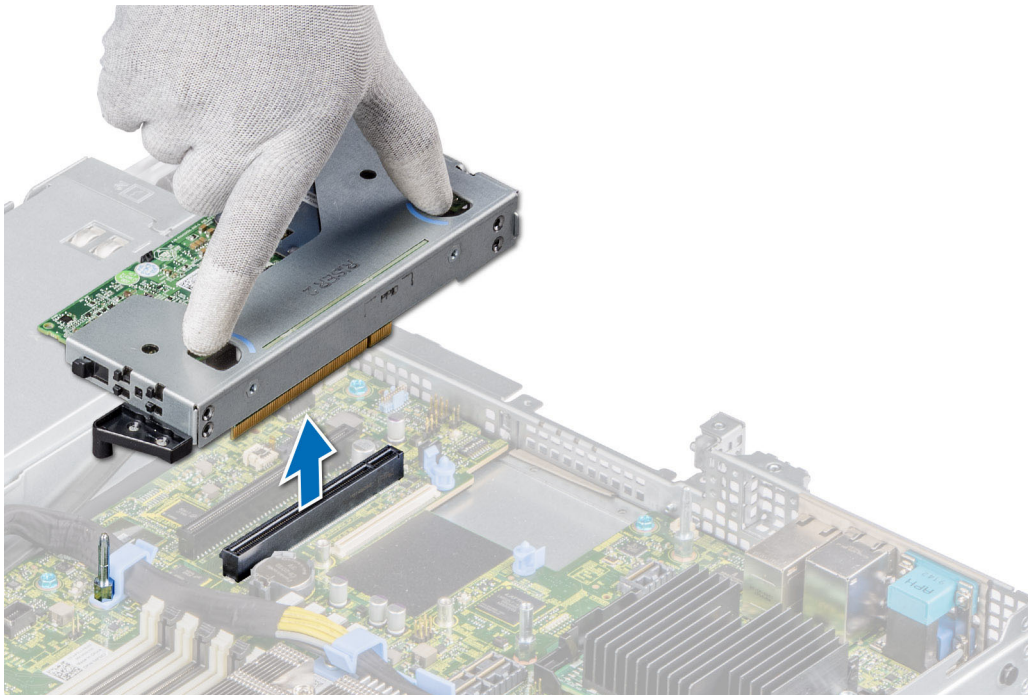
Abbildung 54. Entfernen des linken Risers mit flachem Profil
