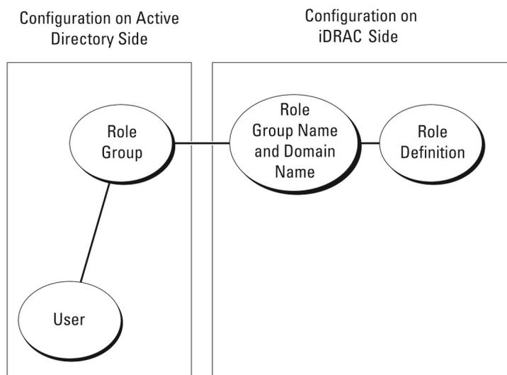
Abbildung 1. Konfiguration von iDRAC mit Active Directory-Standardschema
