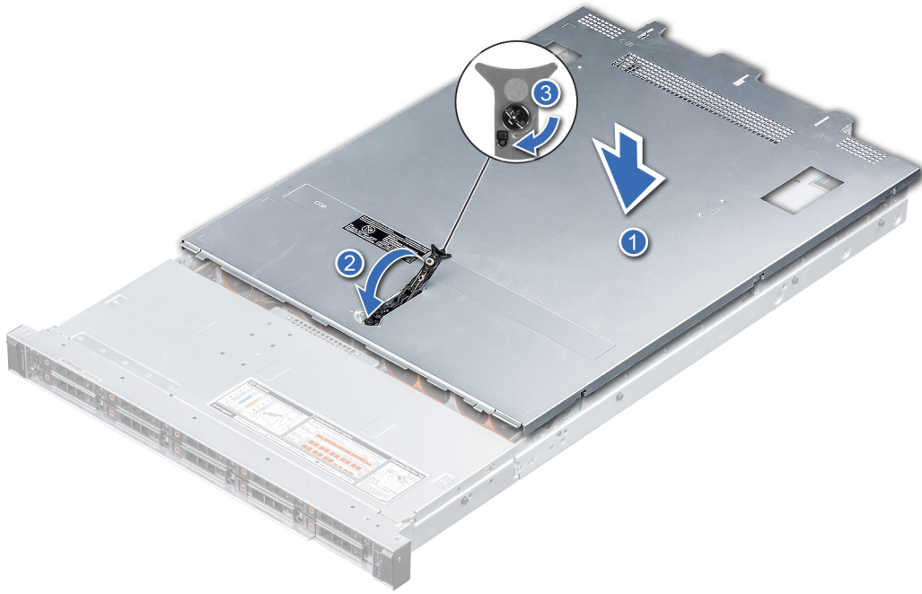
Ilustración 18. Instalación de la cubierta del sistema
