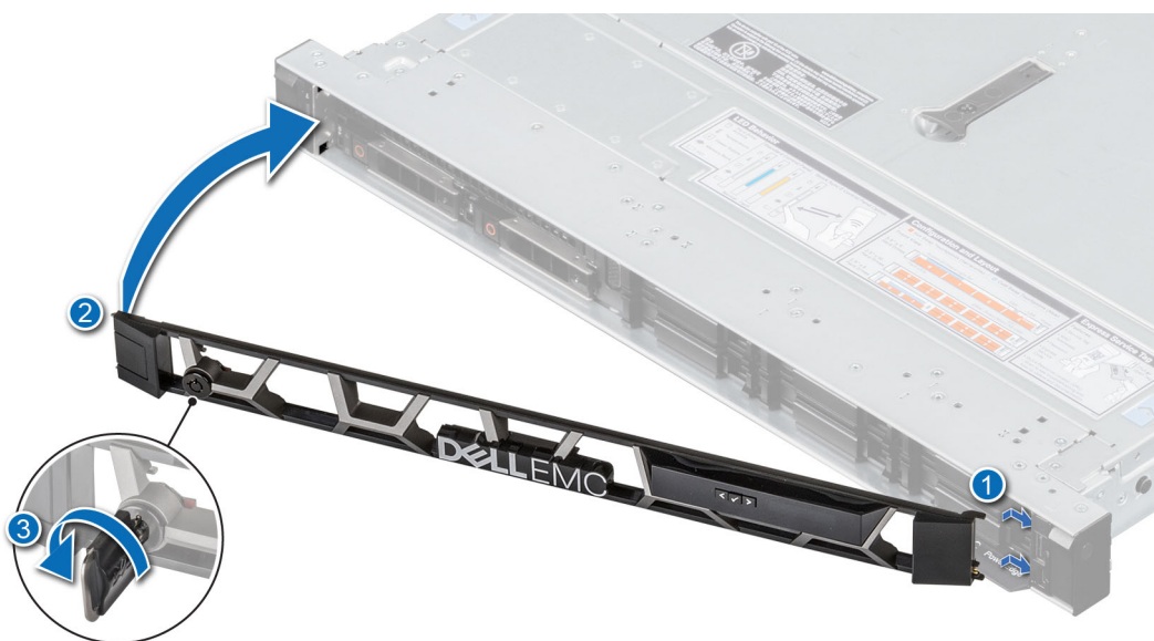
Ilustración 16. Instalación del bisel frontal
