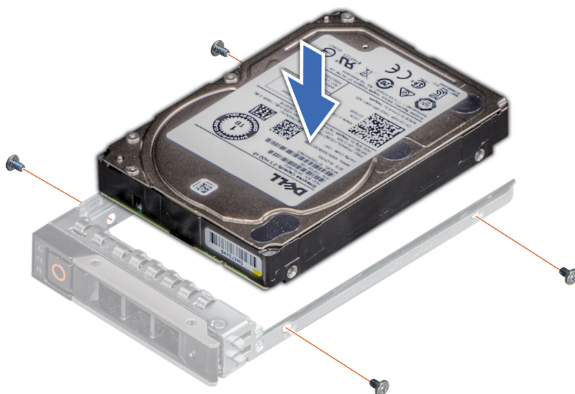
Ilustración 38. Instalación de una unidad en el portaunidades
