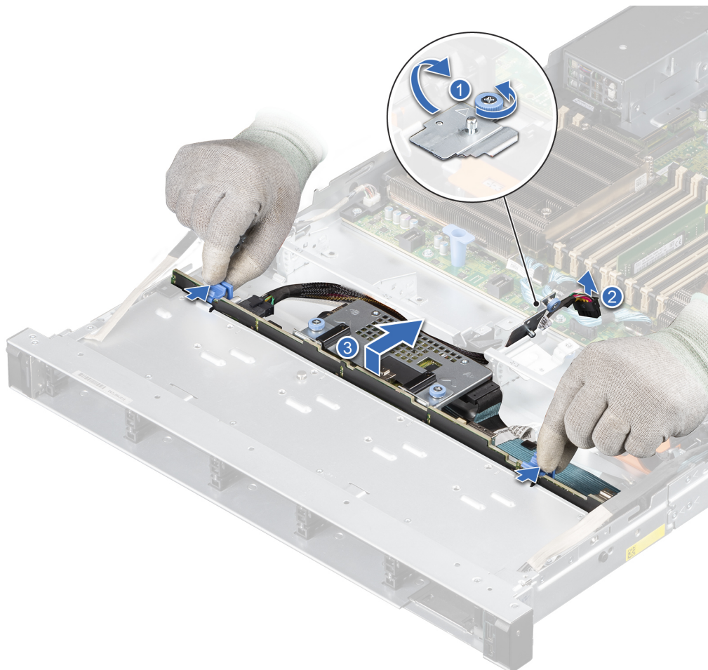
Ilustración 42. Extracción del backplane de la unidad
