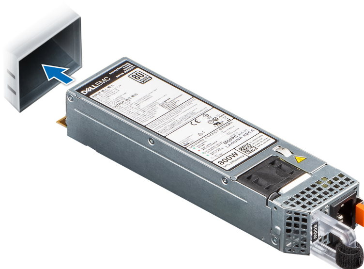
Ilustración 127. Instalación de una fuente de alimentación
