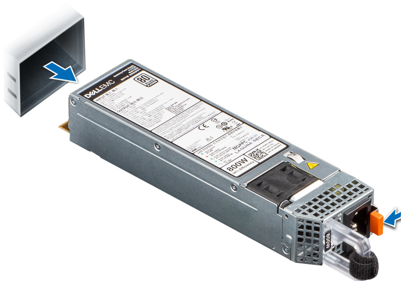
Ilustración 126. Extracción de una fuente de alimentación
