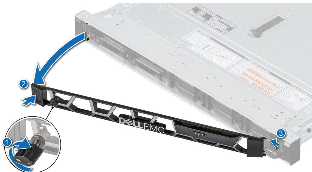
Ilustración 15. Extracción del bisel frontal
