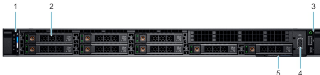
Ilustración 2. Vista frontal del sistema de 8 unidades de 2,5 pulgadas
