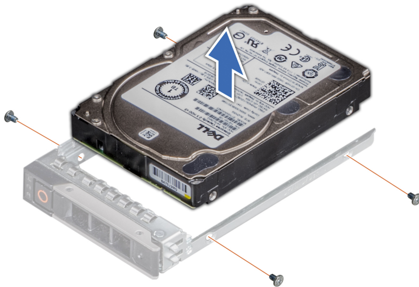
Figure 37. Retrait d'un disque installé dans un support de disque
