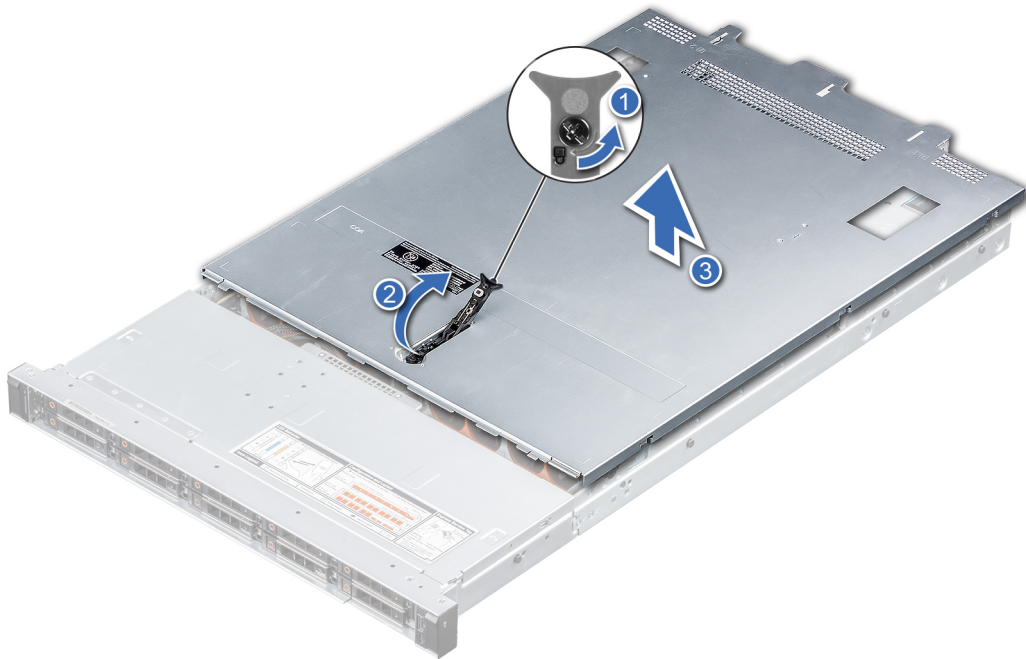
Figure 17. Retrait du capot du système
