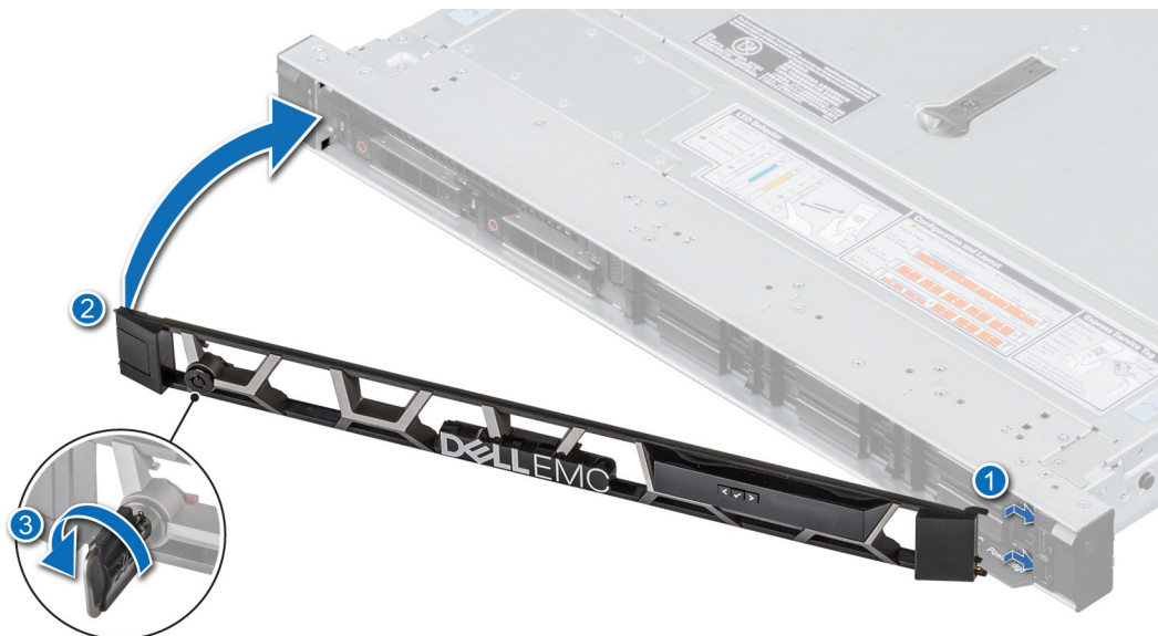
Figure 16. Installation du panneau avant
