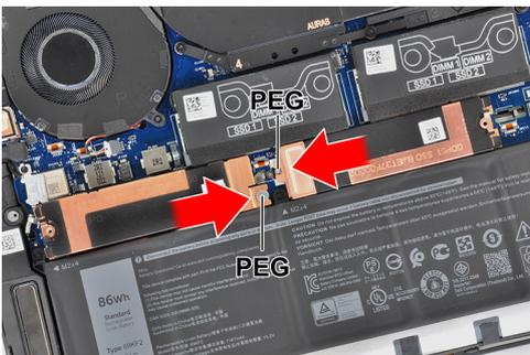
**NOTA:** O tamanho do suporte térmico da unidade de estado sólido varia de acordo com o tipo de armazenamento. Um suporte térmico de unidade de estado sólido projetado para uma unidade M.2 2280 não pode acomodar uma unidade M.2 2230 e vice-versa.
