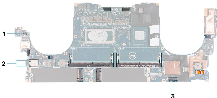
Figura 1. Conectores da placa de sistema
