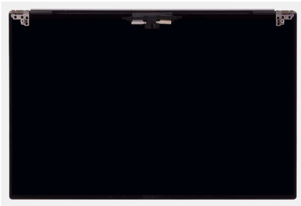
**NOTA:** O conjunto de tela é um conjunto de Hinge-Up Design (HUD) e não pode ser desmontado uma vez que seja removido da parte inferior do chassi. Se algum componente do conjunto da tela estiver com defeito e precisar ser substituído, substitua todo o conjunto da tela.
