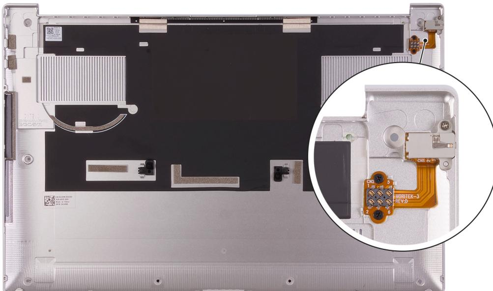
2. Começando no canto inferior esquerdo, use um estilete de plástico para forçar a tampa da base na direção das setas para liberar a tampa do conjunto do apoio para as mãos e teclado.
