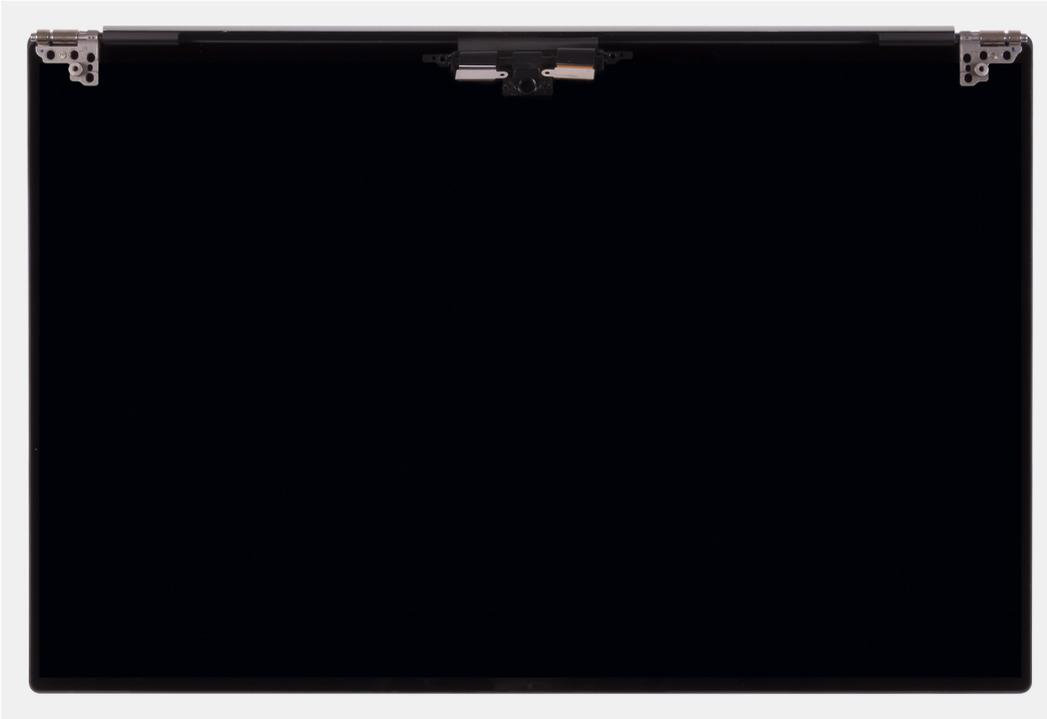
**NOTA:** O conjunto do ecrã tem uma montagem de Design Hinge-Up (HUD) e não pode ser desmontado depois de ser removido do chassis inferior. Se quaisquer componentes no conjunto do ecrã estiverem avariados e necessitarem de ser substituídos, substitua o conjunto do ecrã completo.
