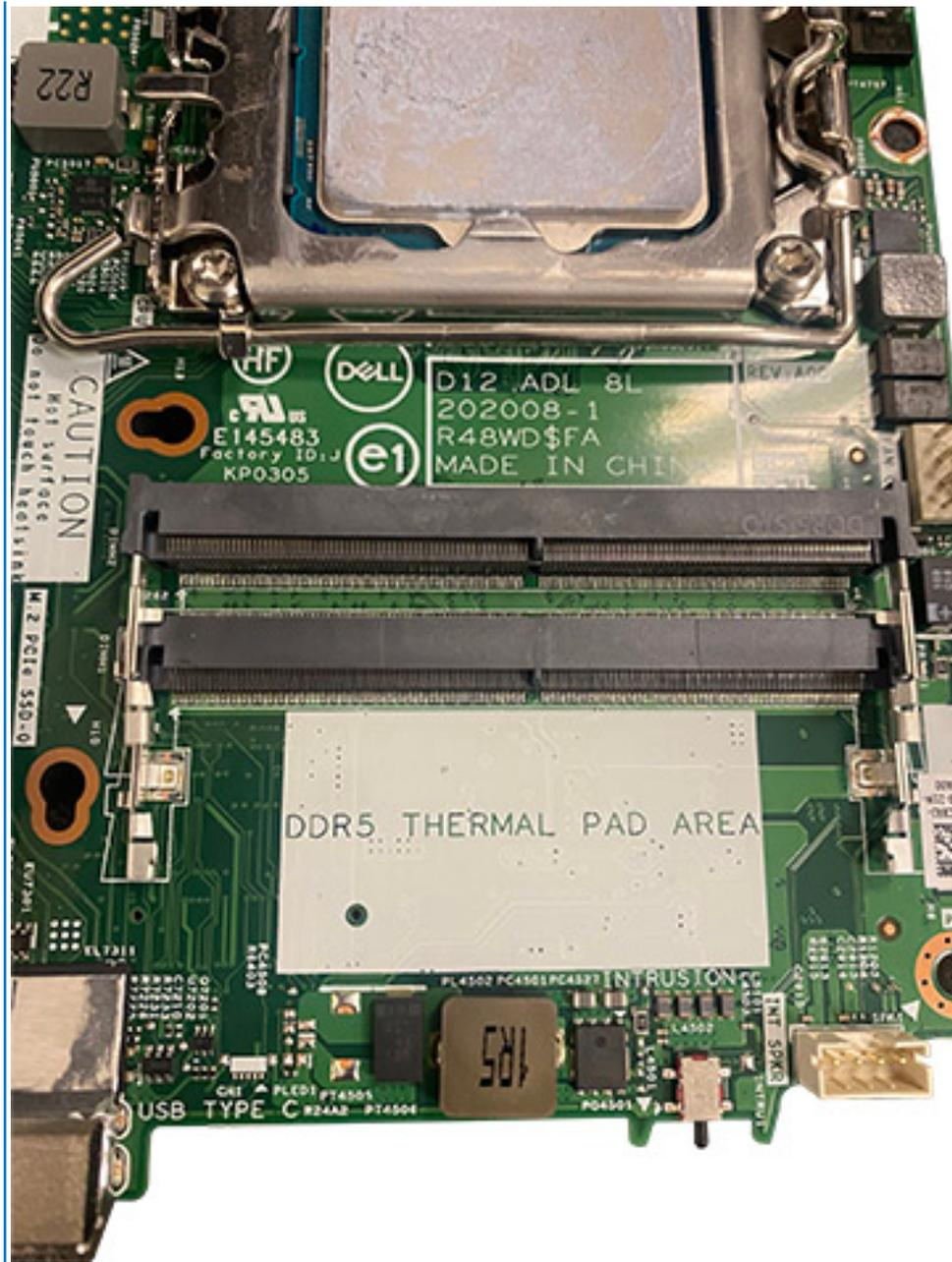
**REMARQUE :** Assurez-vous que le tampon thermique SODIMM est correctement fixé et qu'il n'est pas tordu ou déformé.
