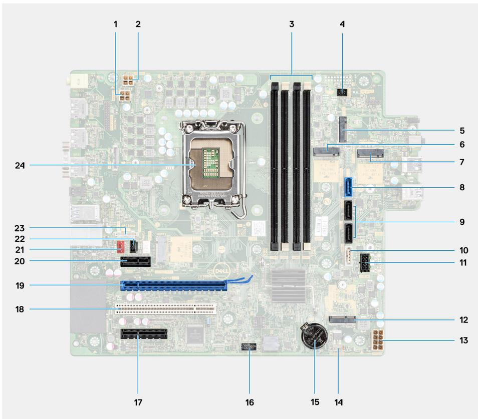
1. ATX CPU-Netzanschluss
