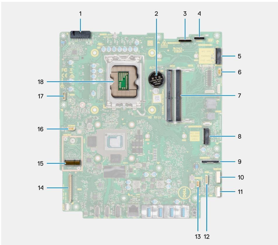
1. Connettore del cavo dell'unità di alimentazione (PSU)
