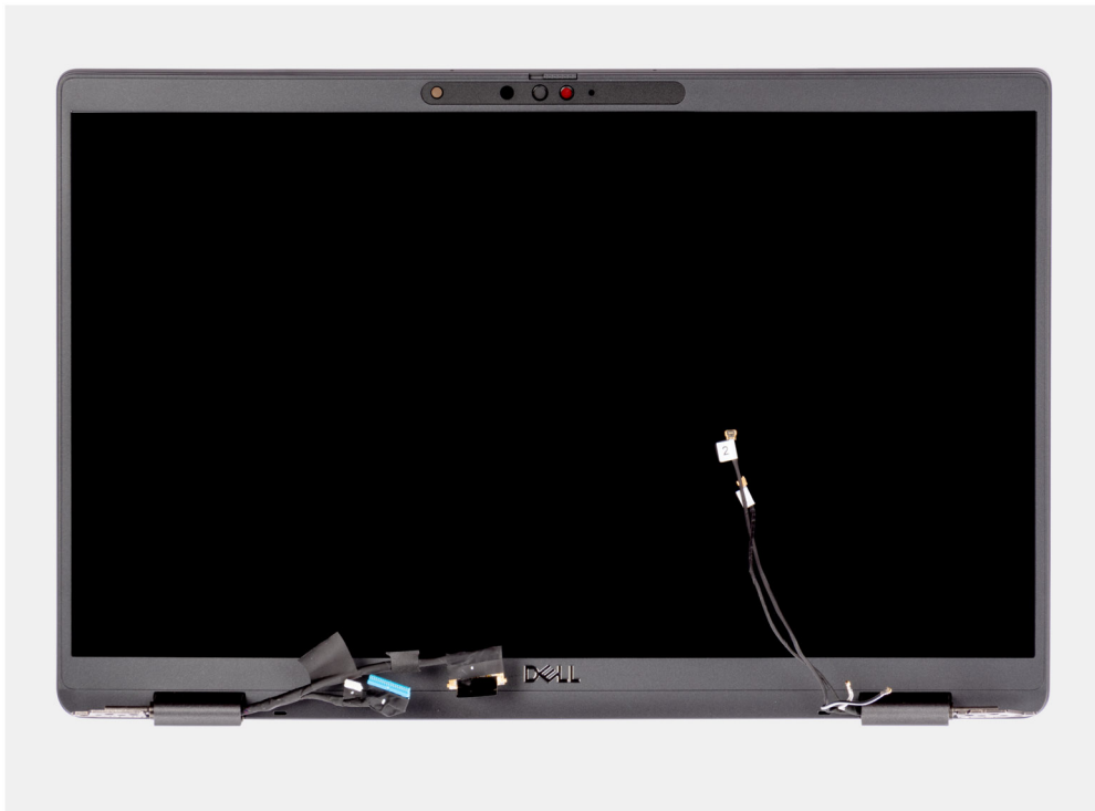
Abbildung 1. Bildschirmbaugruppe mit WWAN-Antennenkabeln
