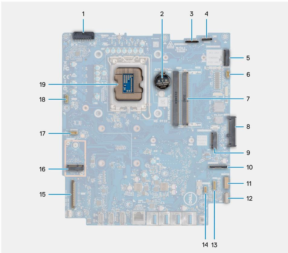
1. Conector del cable de la fuente de alimentación (PSU)
