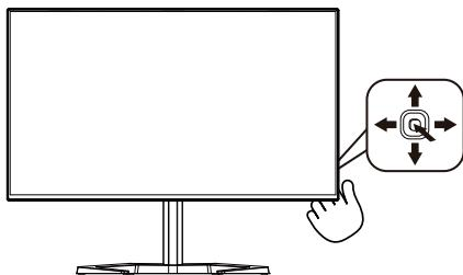
Nabídku OSD tohoto displeje Philips můžete otevřít jednoduše pomocí tlačítka na zadní straně displeje. Jednoduché tlačítko funguje jako joystick. K přesouvání kurzoru prostě přepínajte ovladač čtyřmi směry. Po stisknutí tlačítka lze vybrat požadovanou možnost.
