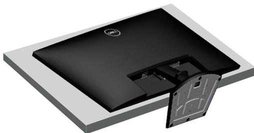
2. Utilize uma chave de fendas para manter pressionado o botão de desengate do suporte e, em seguida, desencaixe o suporte do monitor.
