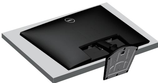
2. Halten Sie die Ständerfreigabetaste mit einem Schraubendreher gedrückt und schieben Sie dann die Ständereinheit aus dem Monitor.
