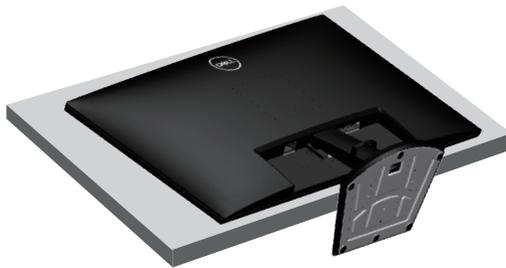
2. Utilisez un tournevis pour appuyer sur le bouton de déverrouillage du support et le maintenir enfoncé, puis faites glisser l'ensemble du socle hors du moniteur.
