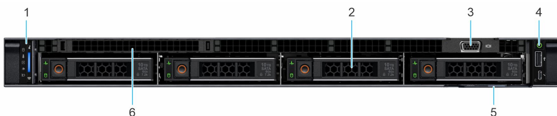
Ilustración 1. Vista frontal de un sistema de 4 unidades de 3,5 pulgadas
