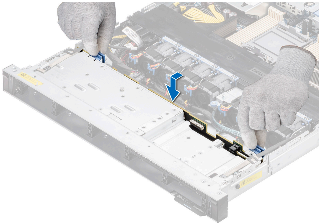
Ilustración 38. Instalación del backplane de la unidad
