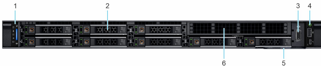
Ilustración 2. Vista frontal de un sistema de 8 unidades de 2.5 pulgadas
