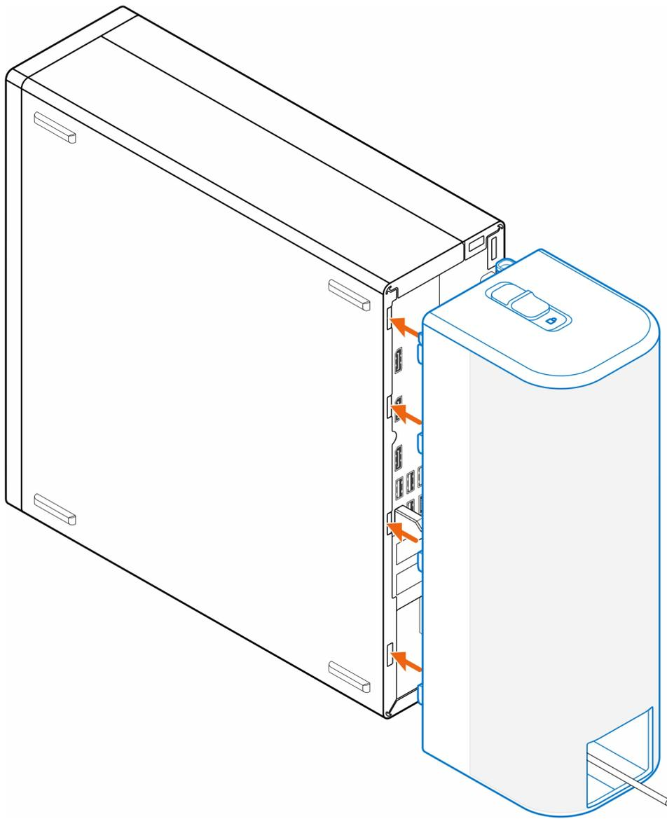
5. Empuje suavemente la cubierta de cables hasta que encaje en su lugar.
