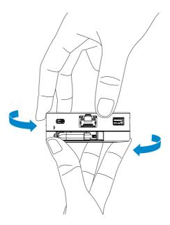
2. Con el Cable USB-C hacia usted, gire la sección superior para liberar el Cable USB-C.
