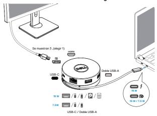
4. El DA305 admite la Transferencia de Suministro de Energía de hasta 90W cuando se conecta al Puerto Thunderbolt o USB-C (Display Port Alt Mode) de su PC. La Energía puede ser suministrada por el Adaptador de Corriente USB-C o el Monitor USB-C con capacidad de Suministro de Energía que admite la función de Carga. Las siguientes dos imágenes muestran un DA305 conectado a una Fuente de Alimentación externa mediante un Adaptador de Corriente USB-C o un Monitor USB-C.
