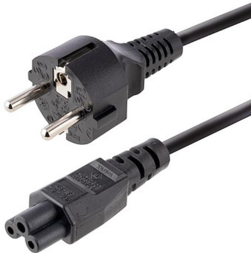
Das 3 m lange Laptop Stromkabel 753E-3M-POWER-LEAD verfügt über einen europäischen Schuko CEE 7 Stecker und einen 3-poligen IEC 60320 C5 Stecker. Es ist ein passendes Ersatz Stromkabel für einen HP, Toshiba oder einen anderen kompatiblen Laptop, der mit einem C6 fähigen Netzteil ausgestattet ist.
