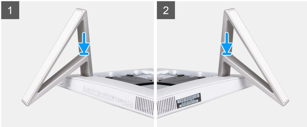
Inserte la base en las ranuras de la cubierta posterior hasta que encaje en su lugar en la base del ensamblaje de la pantalla.
