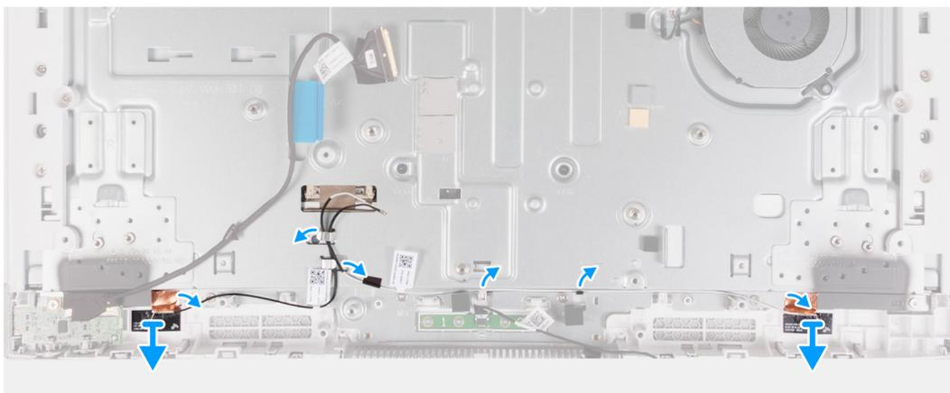
**NOTA:** Anote la colocación de los cables de la antena antes de quitarlos de las guías de enrutamiento. Además, anote la ubicación de los módulos de la antena impresa en la base del ensamblaje de la pantalla como ANT-B (negra) y ANT-W (blanca).
