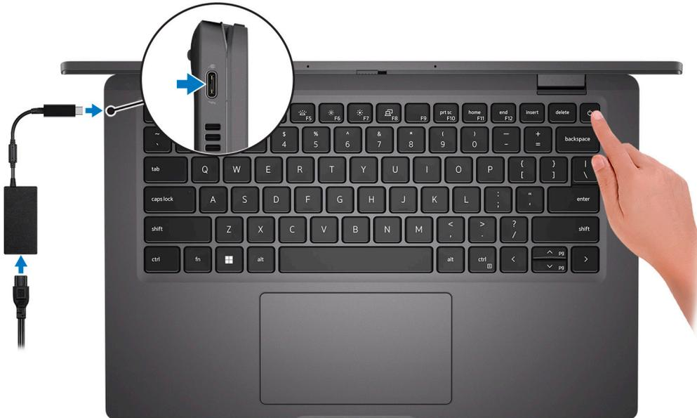
**NOTA:** Para conservar la energía de la batería, es posible que esta ingrese en modo de ahorro energético. Para encender el equipo, conecte el adaptador de alimentación y presione el botón de encendido.
