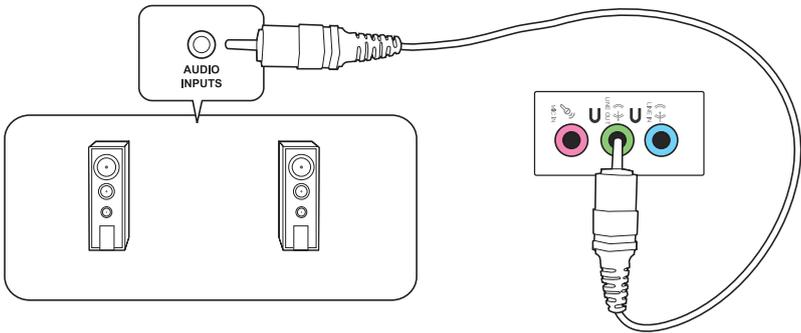
**Collegamento di altoparlanti in configurazione 4**
