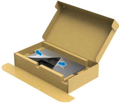
5. Faites glisser les ergots de la colonne dans les fentes du capot arrière de l'écran et appuyez sur le socle pour le mettre en position.
