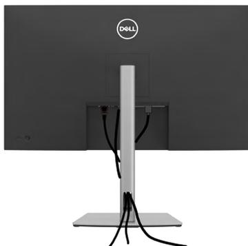
Dopo avere collegato tutti i cavi necessari al monitor ed al computer (fare riferimento alla sezione **Collegamento del monitor** per il collegamento dei cavi), organizzare tutti i cavi come mostrato sopra.
