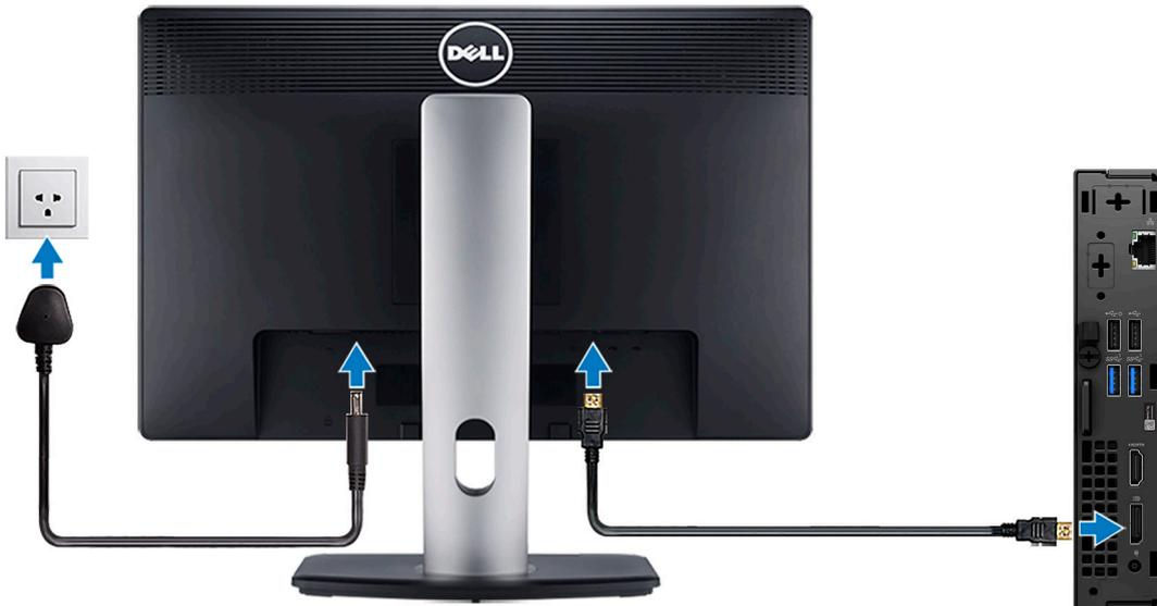
4. Schließen Sie das Stromkabel an.
