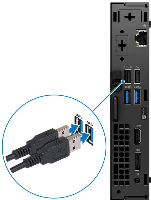
2. Verbinden Sie den Computer über Kabel mit dem Netzwerk oder stellen Sie später eine Verbindung mit einem Wireless-Netzwerk her.
