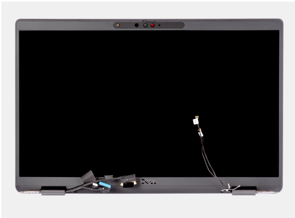
Abbildung 3. Bildschirmbaugruppe mit WWAN-Antennenkabeln
