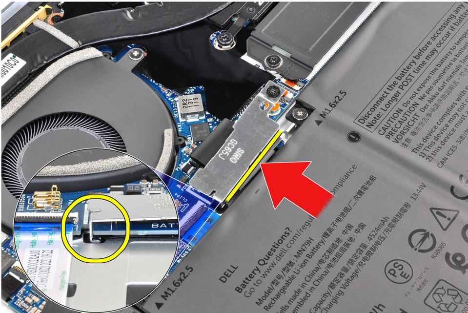
7. Ziehen Sie die unverlierbare Schraube an der Halterung an der Systemplatine fest und stellen Sie sicher, dass der Stift auf der Systemplatine in die Öffnung auf der Halterung des Akkuanschlusses passt.
